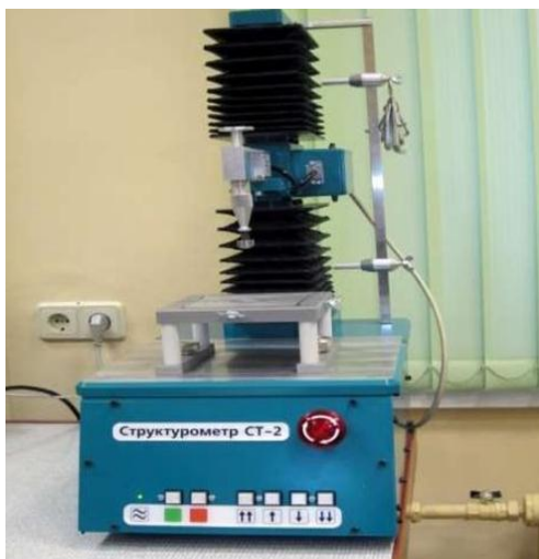
Рисунок 2.2 – Схема приладу структурометр
