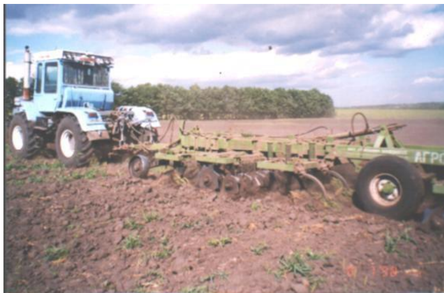
Рис. 3.3. Комбінована ґрунтообробна машина АГРО-3
