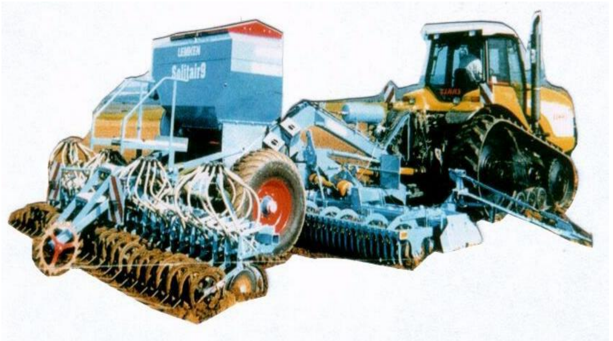
Рис. 1.20. Комбінований агрегат фірми “Лемкен” підготовки ґрунту до сівби та сівбі пневматичною зерною сівалкою “Солітер”
