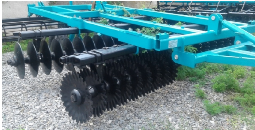
Рисунок 4 – Батарей плоских і рифлених дисків
