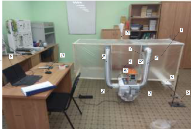
Рисунок 1 – Функціональна схема лабораторної установки: 1 – модель верстата (герметичний резервуар V=0,96 \text{ м}^3 ); 2 – вентилятор; 3 – МЕФ; 4 – годівниця, джерело пилю; 5 – джерело шкідливих газів; 6 - гноєприбиральний канал; 7 – витяжний повітропровід (локальний); 8 - з'єднувальні повітропроводи; 9 - ПК (ноутбук); 10 – ДВН; 11 – контролер; 12 – датчики повітряного середовища; 13 – канал подавання сухого корму
