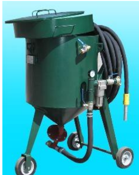
Рис. 1.7 - Піско(дробе) струменевий апарат усмоктувального типу:
