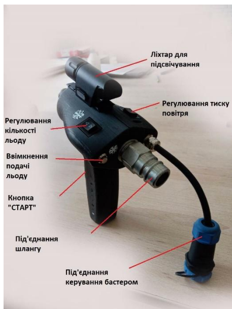
Рис. 3.3 - Експериментальна установка для знежирення та очищення зовнішніх поверхонь техніки при підготовці їх до фарбування.
