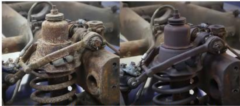
Рис. 2. Приклад очищення поверхонь льодовим струменем
