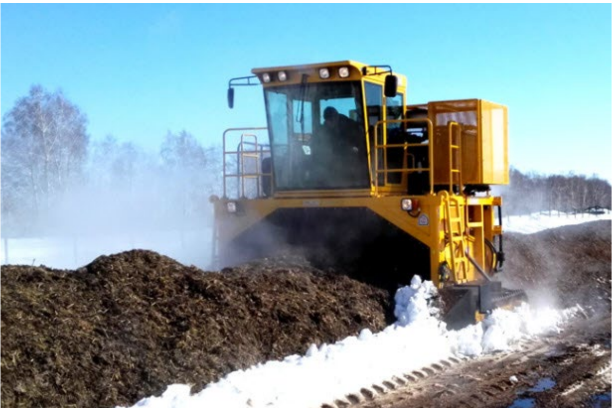
Рисунок 1.2 – Технологія приготування компостів по ходу руху ворущилки буртів: а - агрегатуються; б - самохідної
