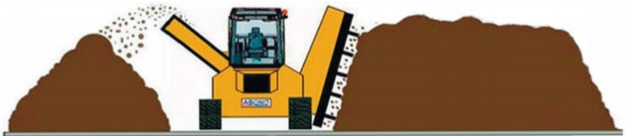
Рисунок 1.5 - Загальний вигляд ворушилки буртів бічного підрізання (а) і технологічний процес обробки компостної суміші (б)
