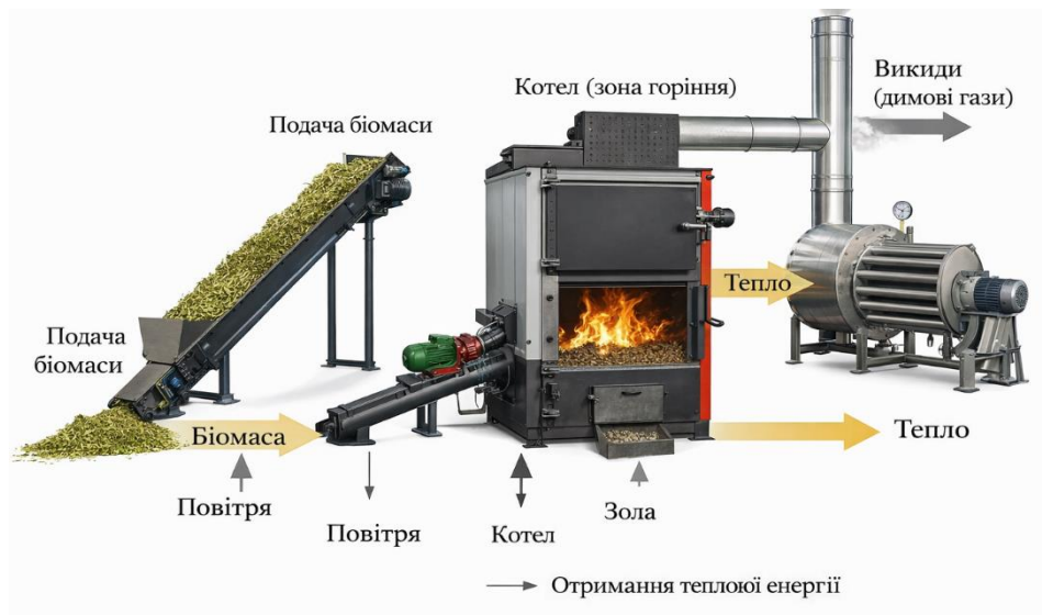
Рисунок 2.3 – Процес спалювання біомаси
