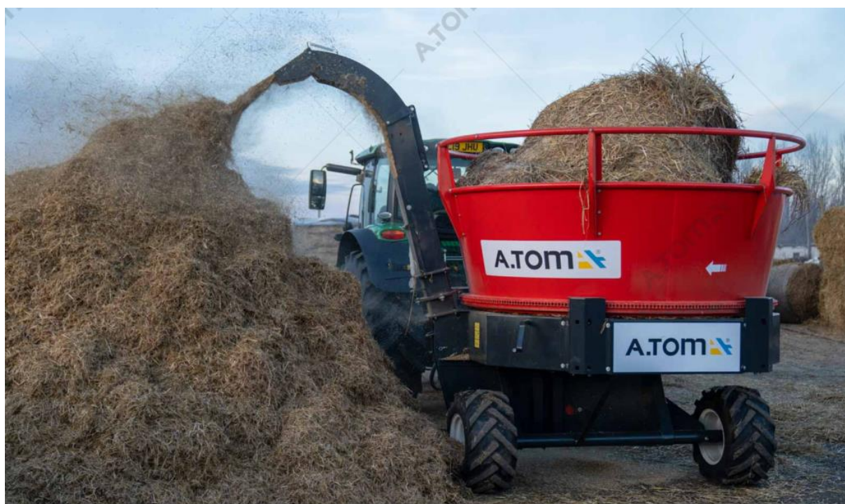
Рис.2.2. Подрібнювач сіна та соломи, тюків А.ТОМ
