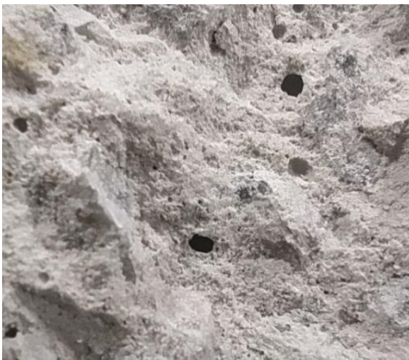
Рис. 7. Порова структура бетону зразка
