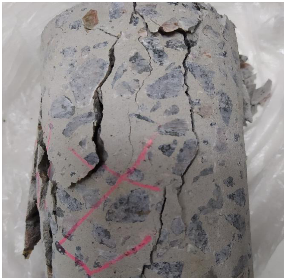
Рис. 10. Характер руйнування зразка підготовленого до випробувань за стандартною методикою
