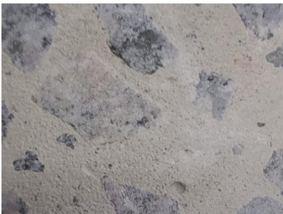
Рис. 6. Цементно-піщана складова бетону керн
