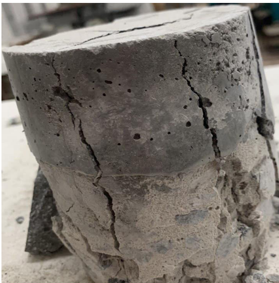
Рис. 11. Характер руйнування зразка підготовленого до випробувань за допомогою ремонтної суміші Mapegrout Thixotropic
