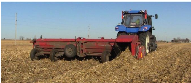
б) двопрохідна система: комбайн з жаткою валкоутворювачем + трактор з прес-підбирачем
