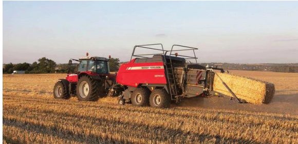
б) двопрохідна система: комбайн з жаткою валкоутворювачем + трактор з прес-підбирачем
