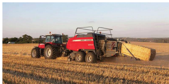
б) двопрохідна система: комбайн з жаткою валкоутворювачем + трактор з прес-підбирачем
