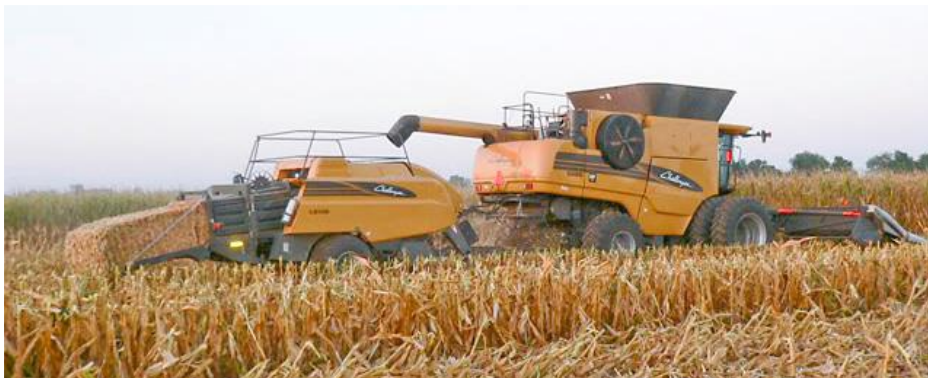
а) однопрохідна система: комбайн з прес-підбирачем
