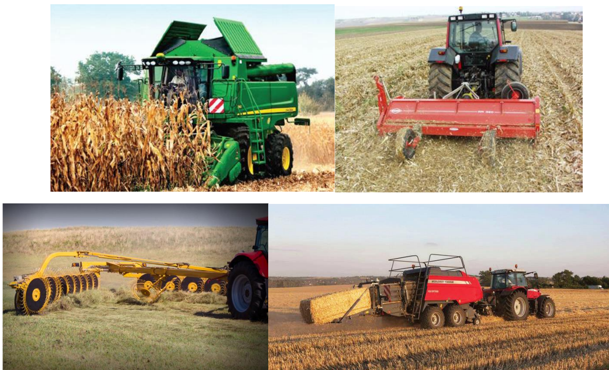
г) Багатопрохідна система: комбайн + трактор з мульчувачем +трактор з граблями + трактор з прес-підбирачем
