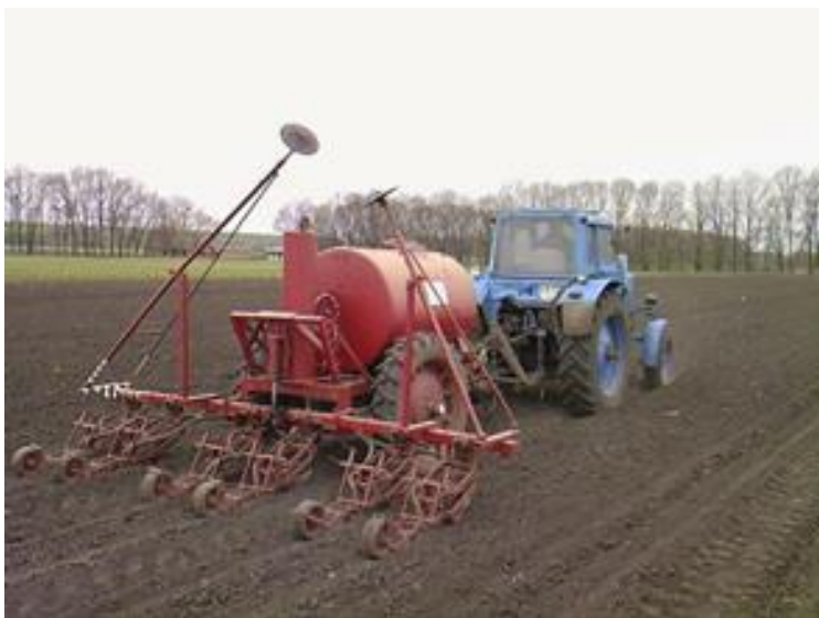
Рисунок 1.7 – Гідравлічна сівалка СГО-4,2
