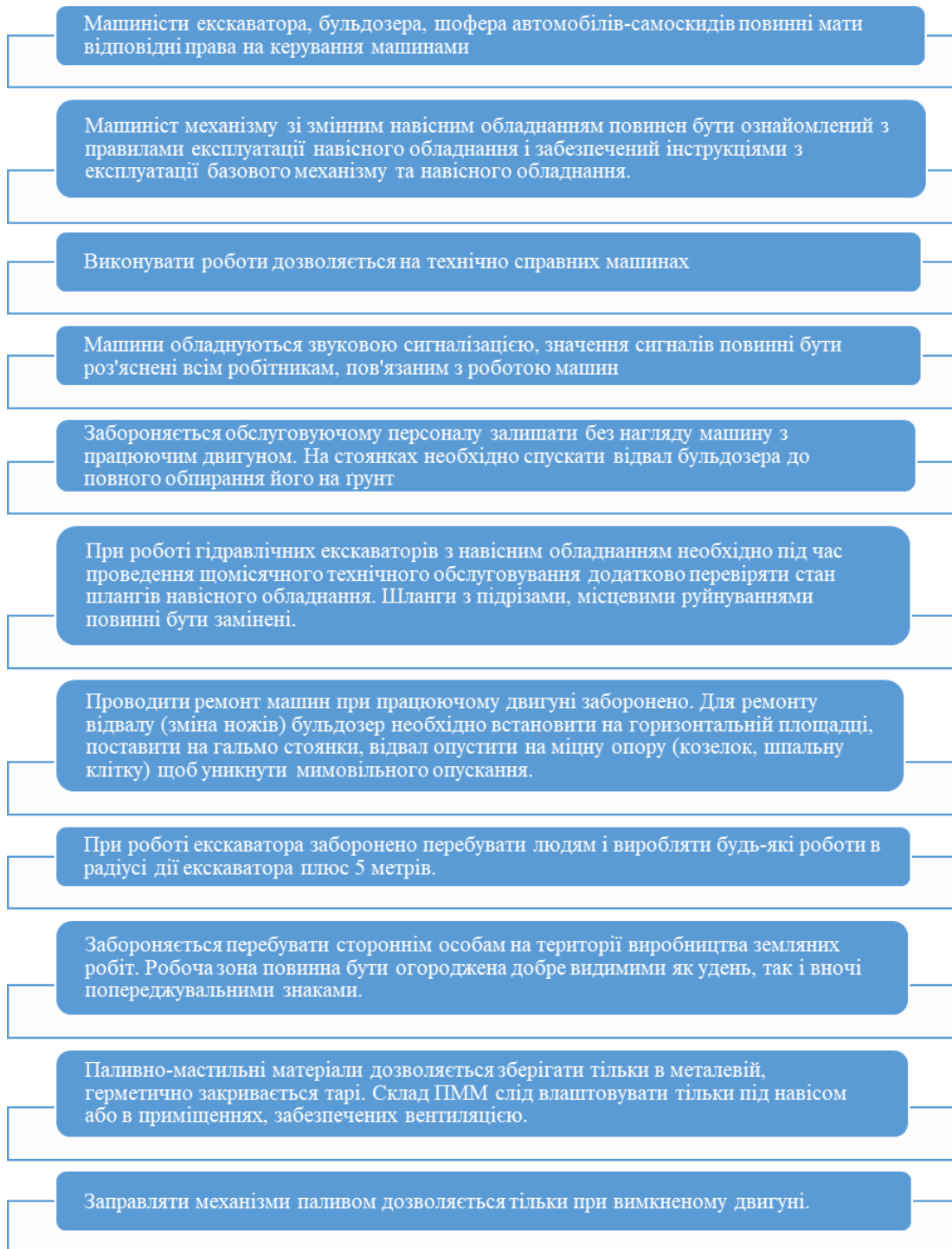
Рисунок 3.3. Основні правила щодо забезпечення норм техніки безпеки та охорони праці під час роботи землерийних та монтажних машин на будівництві регулюючого басейну
