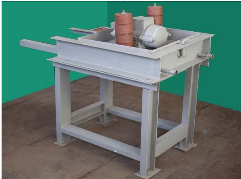
Рис. 1. Конструкційно-технологічна схема (а) та загальний вигляд (б) малогабаритної плитно-валяльної машини: 1 – нижня нерухома плита; 2 – верхня рухома плита; 3 – дебалансний вібродвигун; 4 – піддон; 5 – зона валяння; 6 – зона формування та зволоження заготовок; 7 – рифлі
