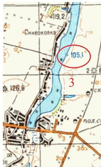
Рисунок 4.6 – Визначення площі заростання водойми: 1 – зарослі очерету та водної рослинності, 2 – відкрита водна поверхня, 3 – відмітка НІР (карти генштабу), 4 – вхідний оголовок шахтного водоскиду
