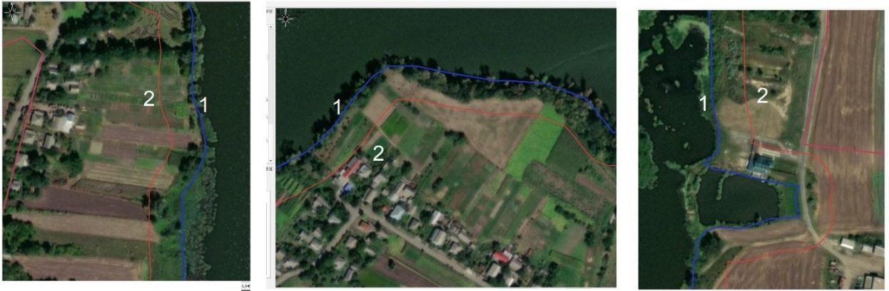
Рисунок 4.17 – Приклади порушень Водного Кодексу в межах ПЗС водосховища на р. Кропивна біля с. Синьооківка: 1 – уріз води при НПР, 2 – межі ПЗС
