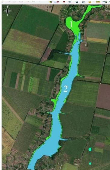
Рисунок 4.6 – Визначення площі заростання водойми: 1 – зарослі очерету та водної рослинності, 2 – відкрита водна поверхня, 3 – відмітка НІР (карти генштабу), 4 – вхідний оголовок шахтного водоскиду
