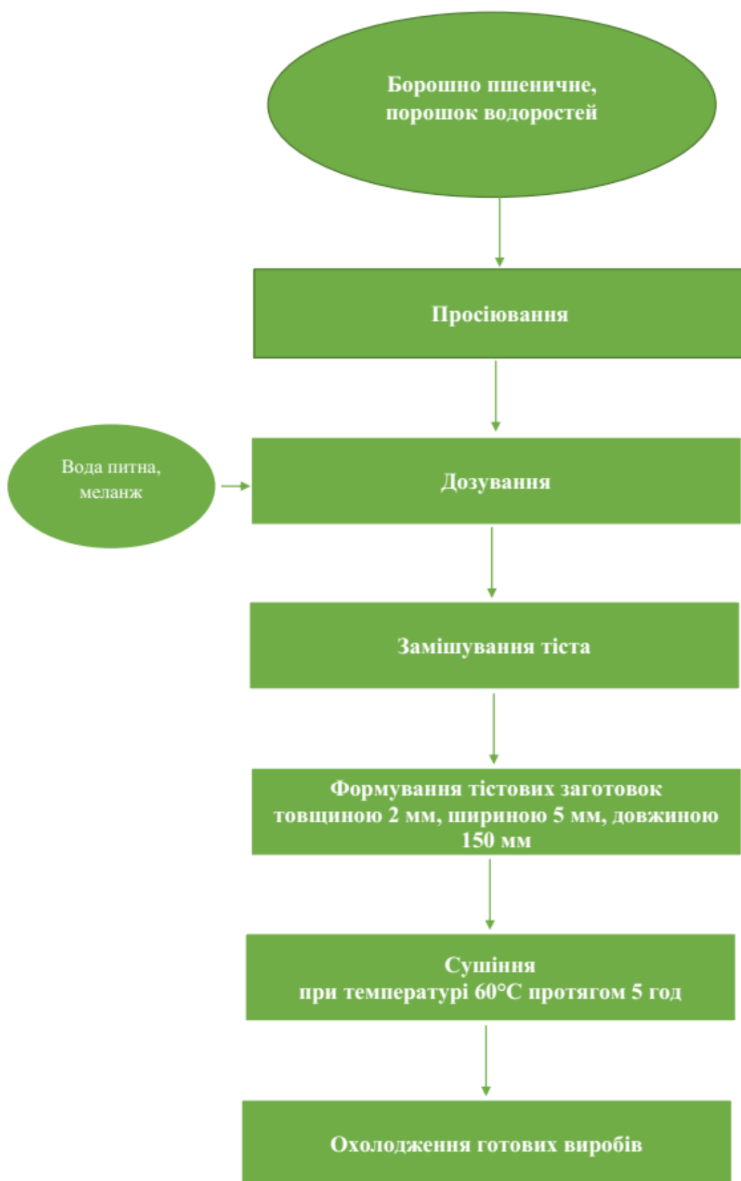
Рисунок 2.2 – Блок-схема виготовлення дослідних зразків локшини з додаванням порошоків водоростей
