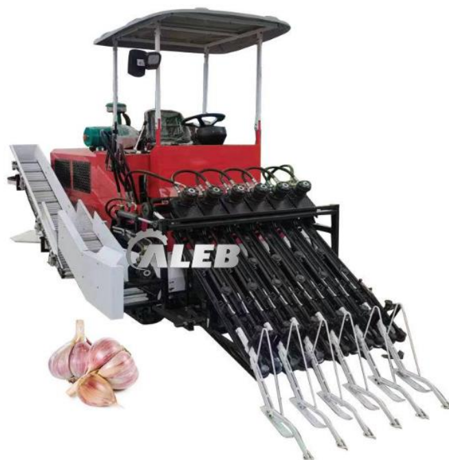
Рисунок 2.7 – Збирачі з стрічковими транспортерами з гумовим або полімерним покриттям [18]
