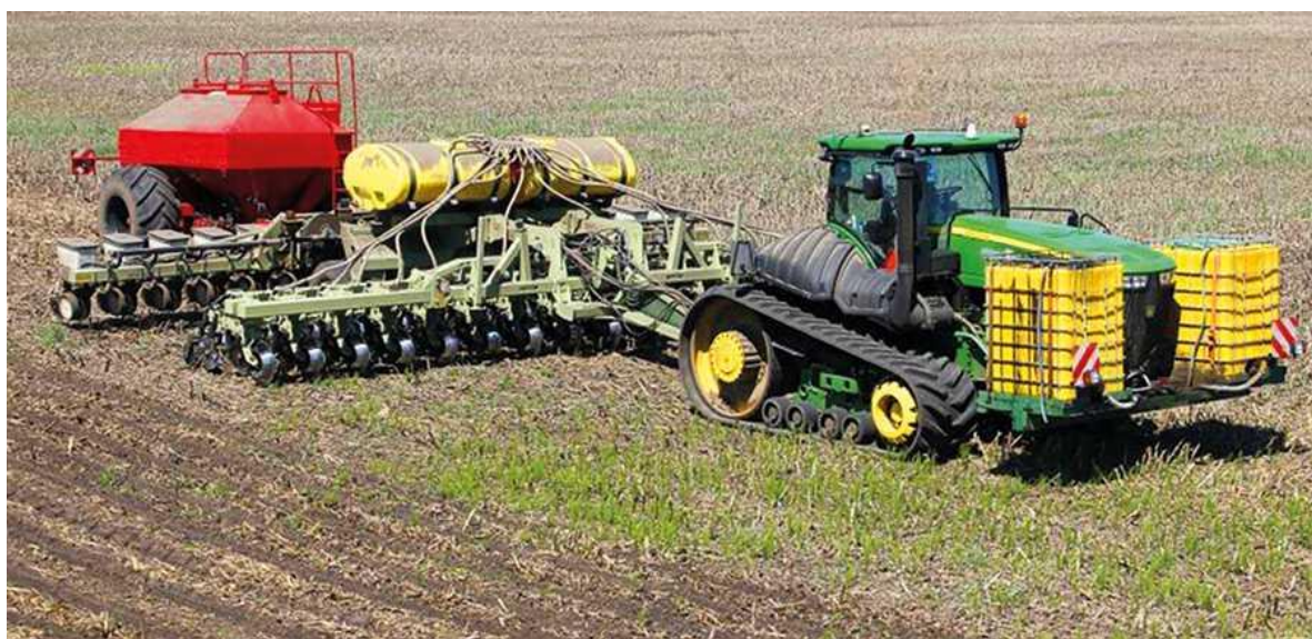
Рис. 2.1. – Операція посіву за технологією No-Till
