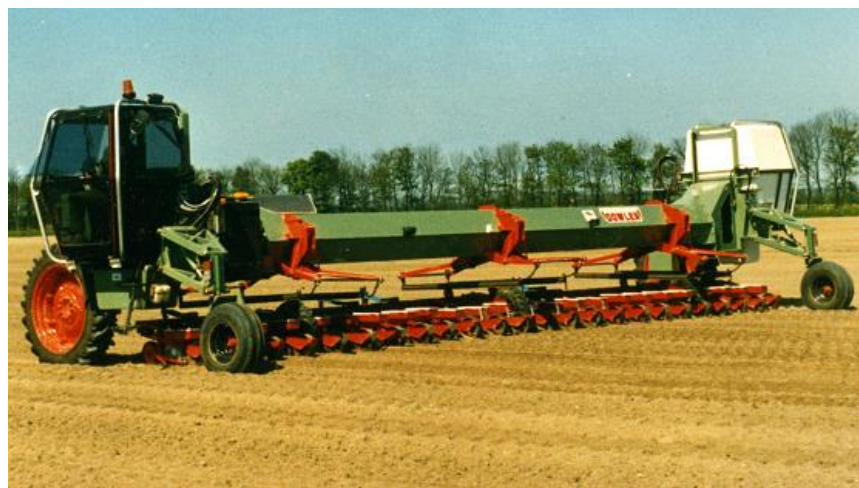
Рис. 2.3. Портальний трактор мостового типу Д. Довлера
