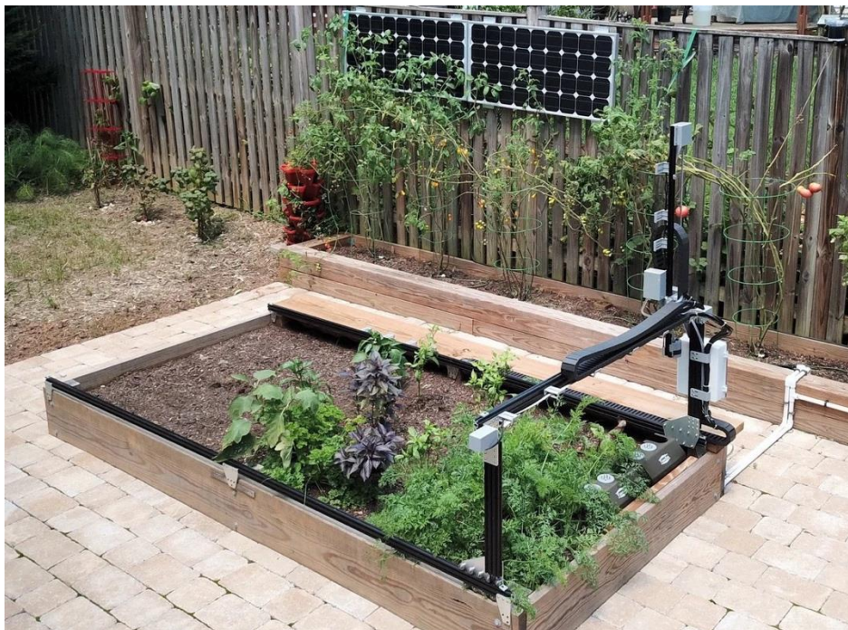
Рис. 2.5. Модульна система мостового типу FarmBot
