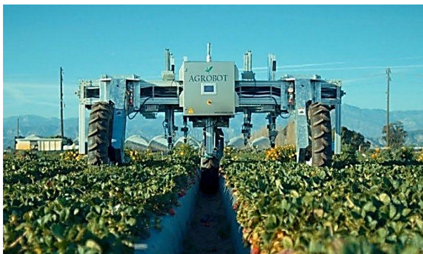
Рис. 1.8. Роботизована платформа Agrobot для збору урожаю в рослинництві [10]
