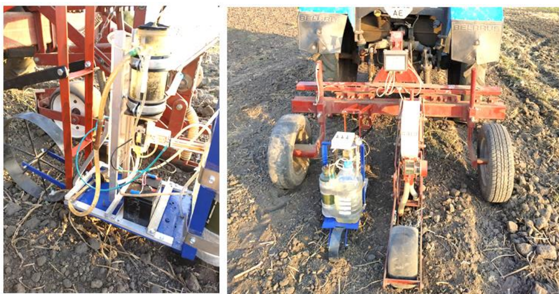
Рис.1.6. Сівалка для точного координатного висіву насіння овочевих культур
