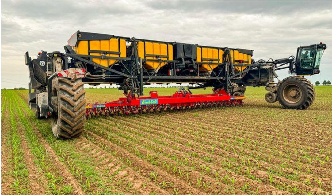
Рис.2.6. Системний трактор мостового типу Nexat
