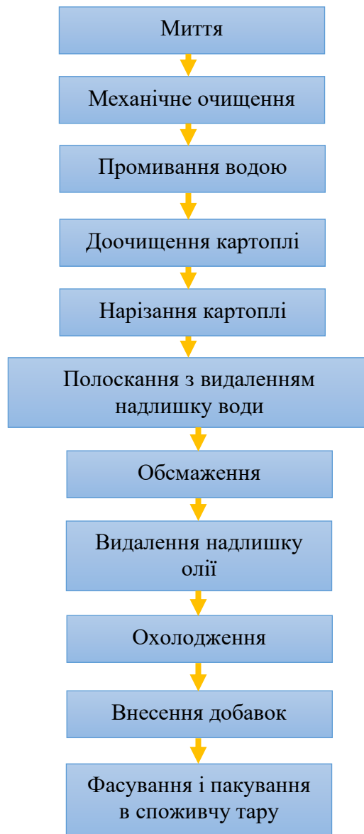
Рисунок 1.1 – Схема виробництва хрусткої картоплі
