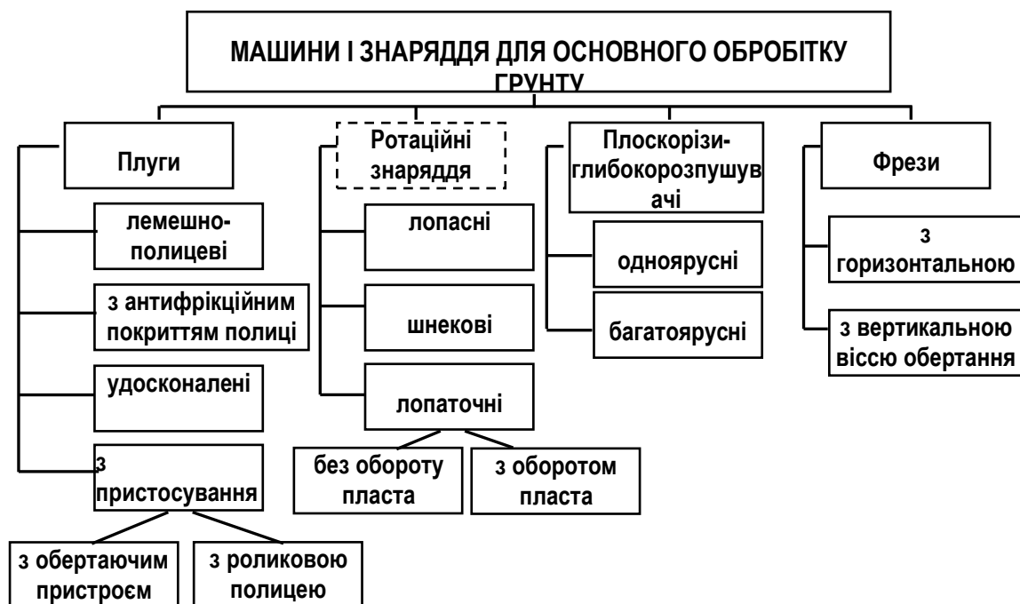
Рисунок 1.1 - Класифікація машин і знарядь для основного обробітку ґрунту
