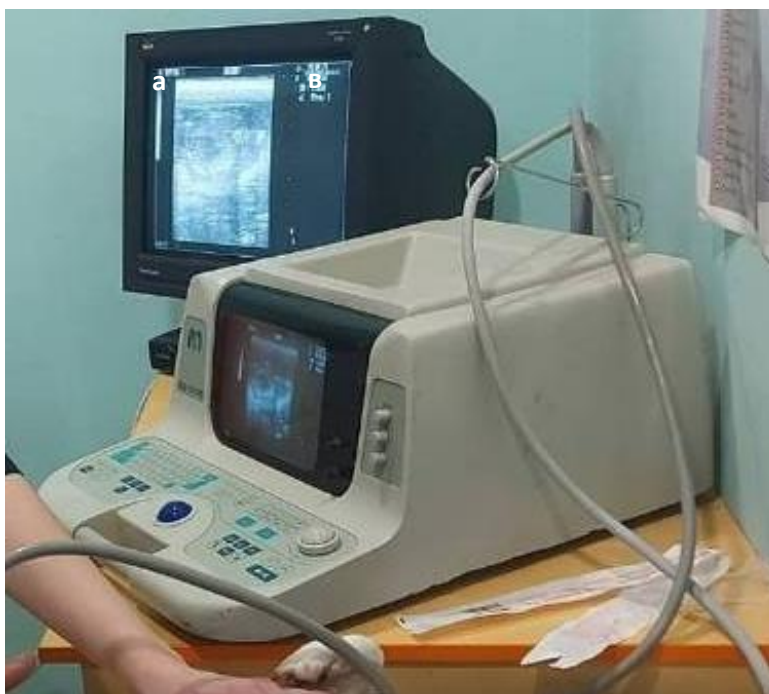
Рис. 1. Обладнання ветеринарної клініки «Звірятко»: переносний ультразвуковий сканер SLE-101PC з електронним скануванням
