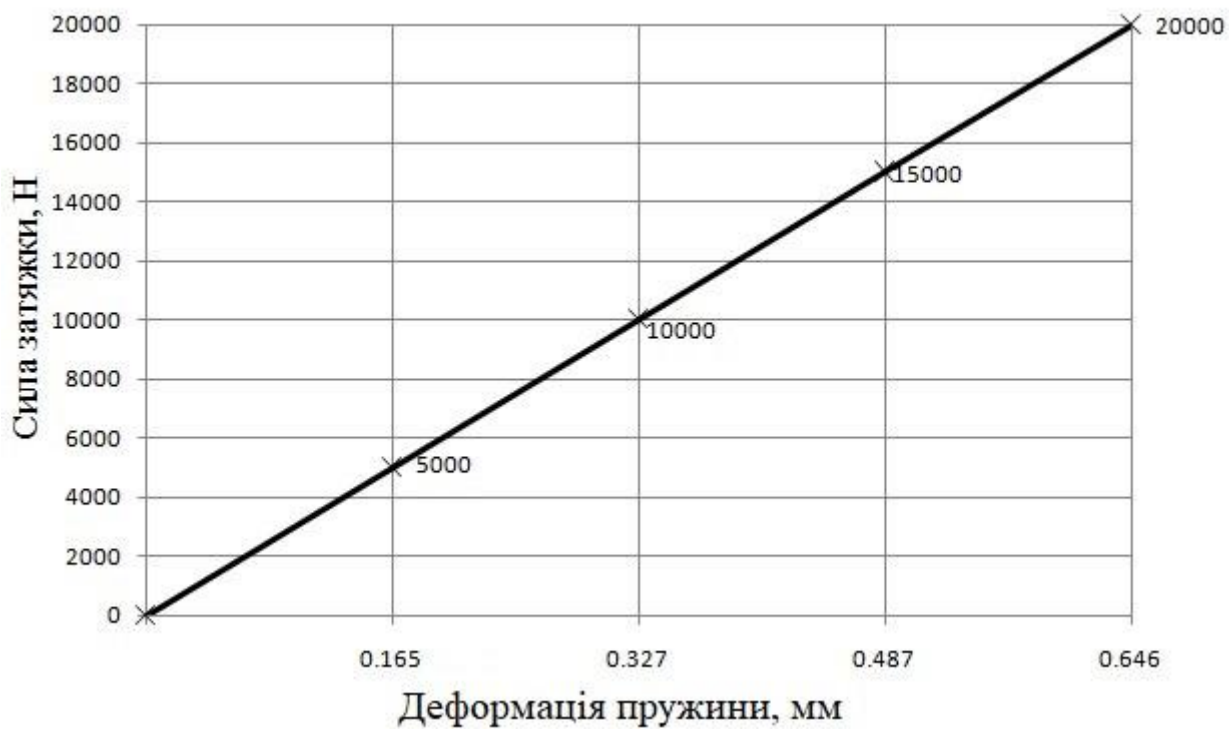
Рис. 3.10. Тарувальна характеристика динамометричної пружини
