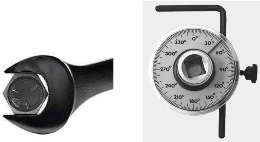
Рис. 1.17. Метод контролю сили затяжки по углу поворота болта (гайки)
