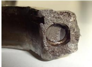
Руйнування шатунного болта внаслідок виникнення мікротріщини, яка в свою чергу виникла із-за перетягування з'єднання
