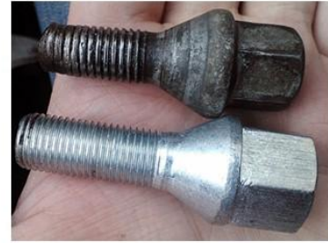
Знос різьби болта кріплення колеса внаслідок недотягування
