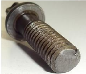
Руйнування шатунного болта внаслідок виникнення мікротріщини, яка в свою чергу виникла із-за перетягування з'єднання
