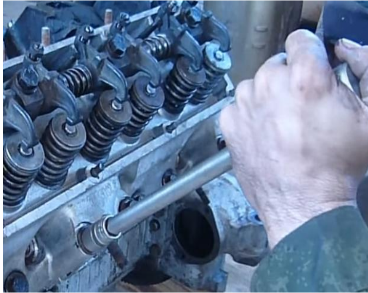
Рис. 3.15. Нанесення на болти моторного масла і їх встановлення
