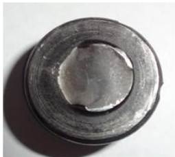
Відламана головка шатунного болта та зона початку розвитку мікротріщини
