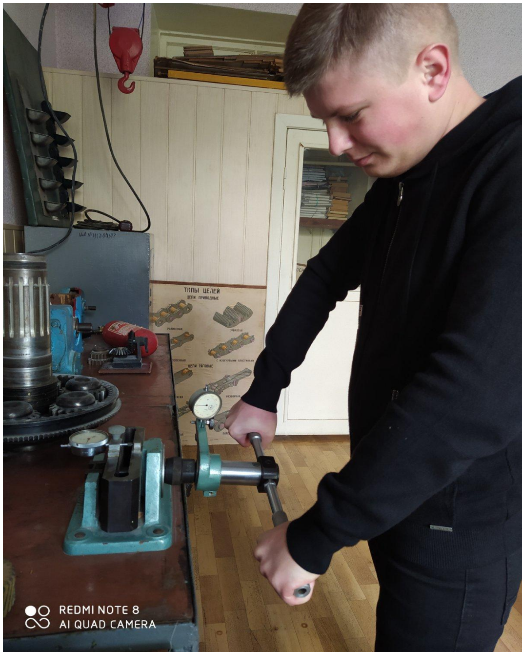
Рис. 3.8. Замір сили затягування
