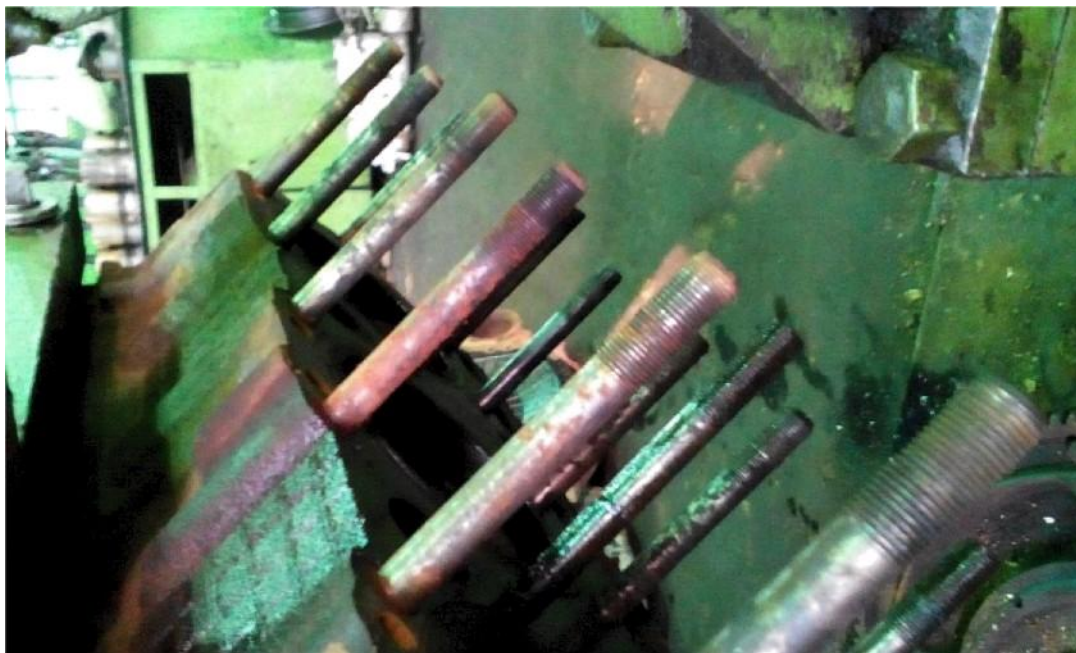
Рис. 1.12. Шпильки ГБЦ перед складанням двигуна ЯМЗ-238 після мийки
