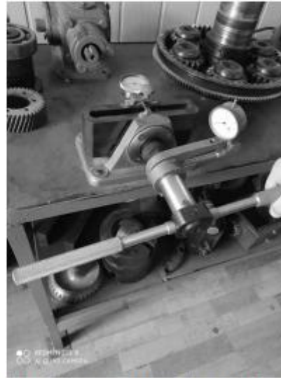
Рис. 3. Установка для дослідження різьбових з'єднань ДМ-27
