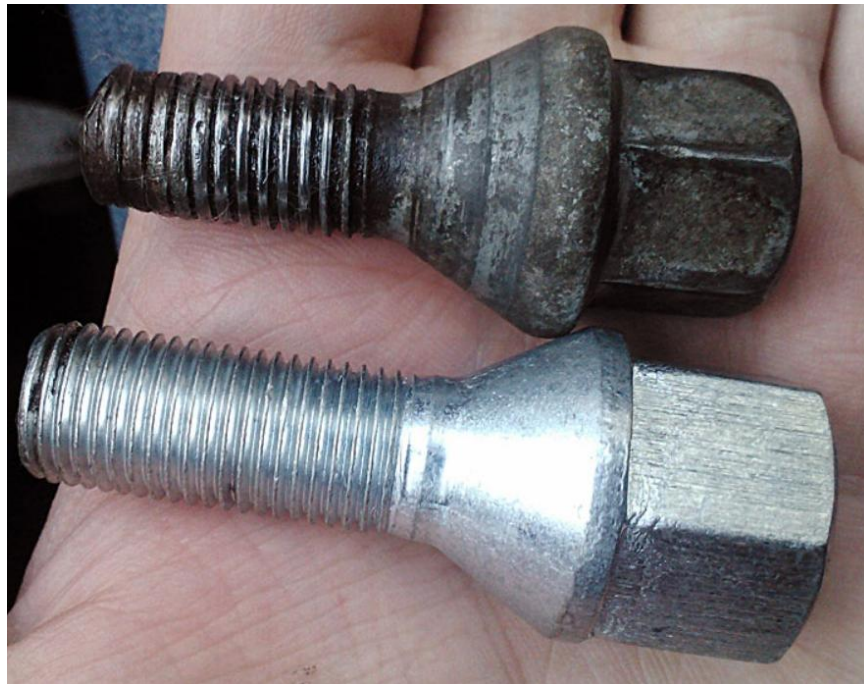
Рис. 3.3. Знос різьби болта кріплення колеса внаслідок недотягування
