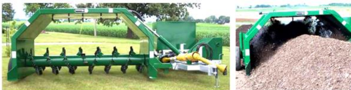
Рисунок 3.2 – Причіпний аератор-перелопачувач компостних буртів Aeromaster PT-130: а – загальний вигляд; б – робочий процес перелопачування бурта
