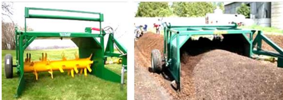
Рисунок 3.3 – Причіпний аератор-перелопачувач компостних буртів Sittler 507 з пристроєм для покривання бурта плівкою
