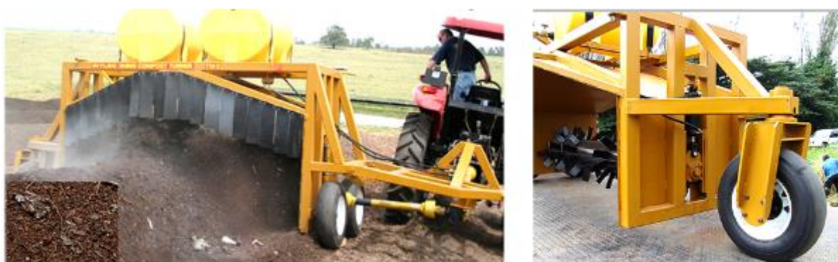
Рисунок 3.4 – Причіпний аератор-перелопачувач компостних буртів Ritlee-TM3 Compost Turner
