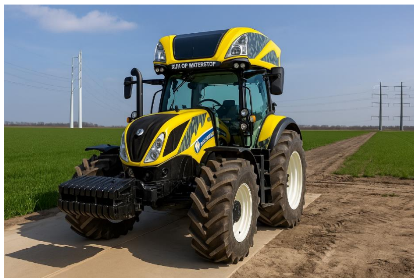
Рис. 2.12. Розміщення балонів на даху кабіни трактора
