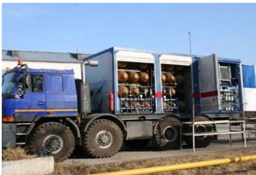
Рис. 2.6. Заправник з активним методом заправки газу ПГАЗ-1200-К
