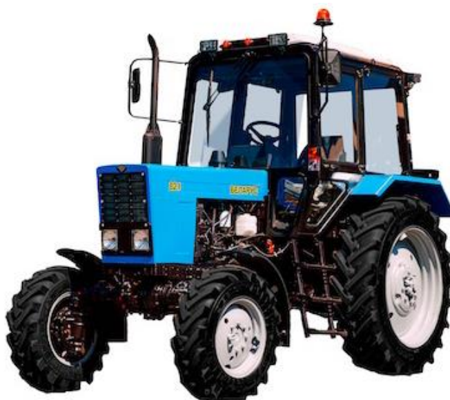
Рис. 2.1 Універсально-просапний трактор МТЗ-82.1
