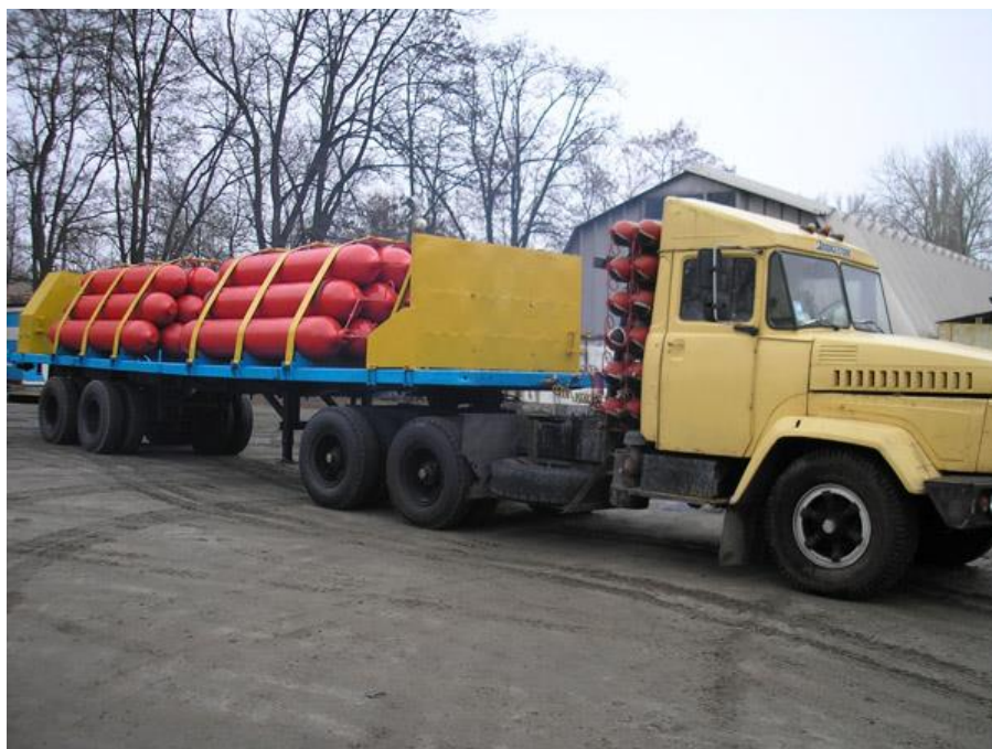
Рис. 2.5. Мобільний заправник пасивного методу заправки КрАЗ-ПАГЗ 3000
