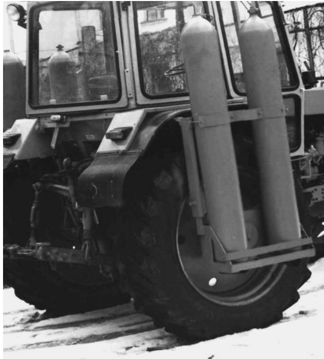
Рис. 2.8. Бокове розміщення балонів напівосях
