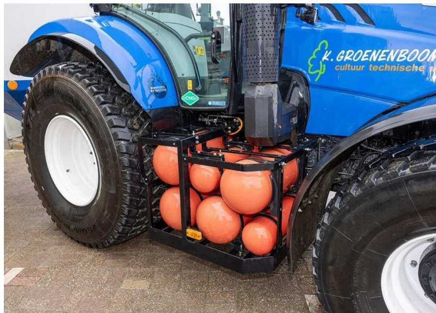
Рис. 2.9. Бокове розміщення балонів на тракторі New Holland T6
