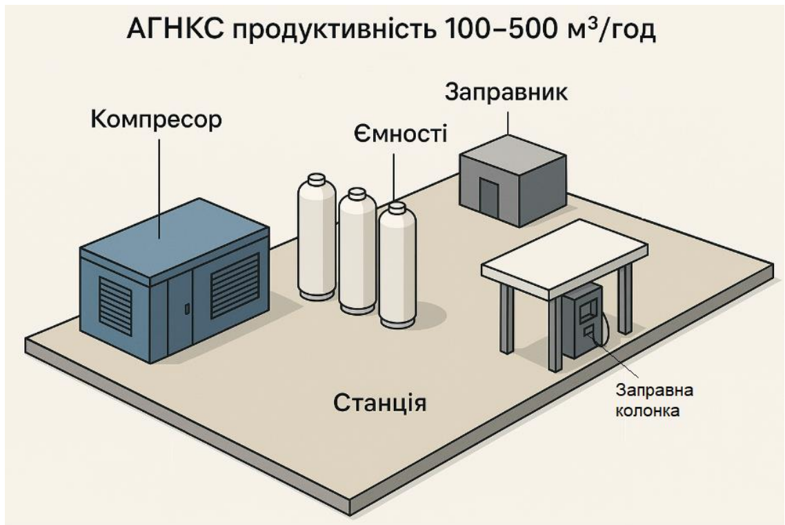
Рис. 2.3. Загальний план АГНКС з розміщенням основних складових
