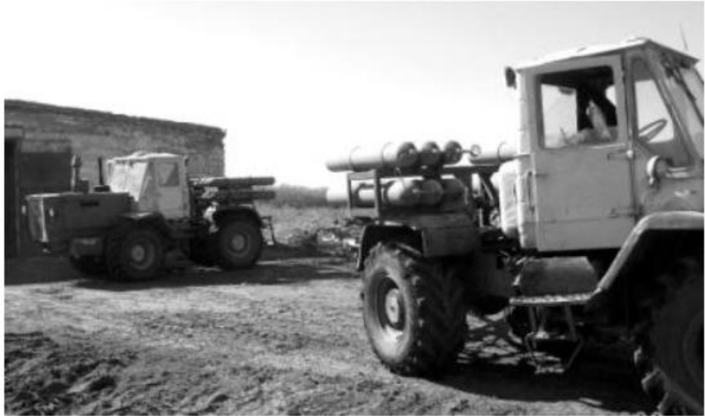
Рис. 2.11. Спосіб розміщення балонів на тракторах з шарнірно зчленованими рамами типу ХТЗ-150К
