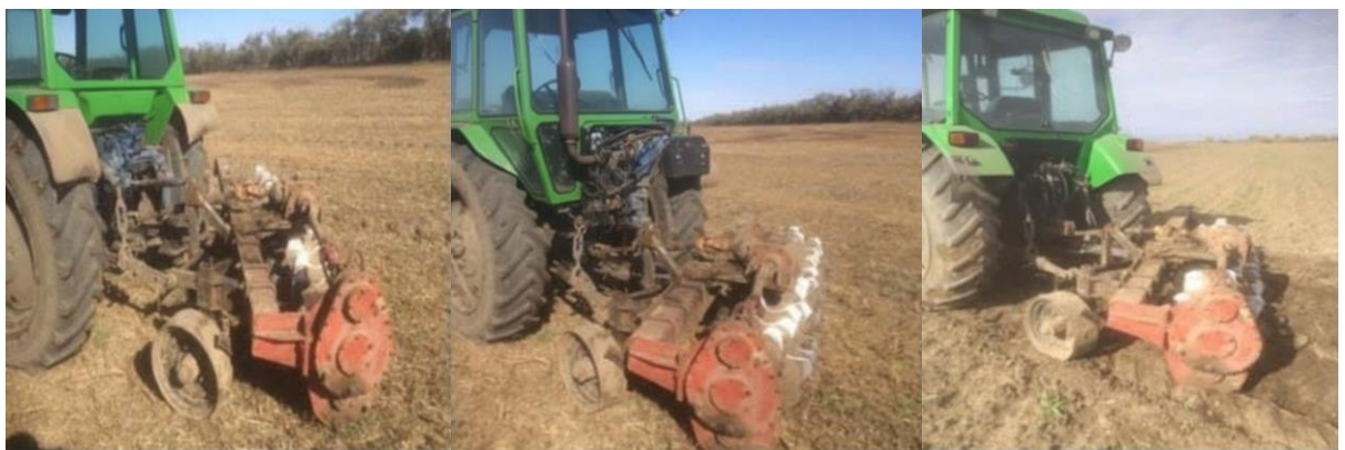
Рисунок 3.3 - Варіанти кута атаки роторного плуга: 30°, 24°, 18°
