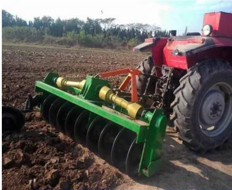
Рисунок 1.9 – Навісний ротаційний плуг марки 1LYQD
