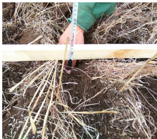
Рисунок 3.7 – Визначення гребнистості поверхні ґрунту
