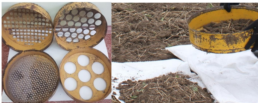
Рисунок 3.8 – Комплект сит для визначення фракційного складу ґрунту
