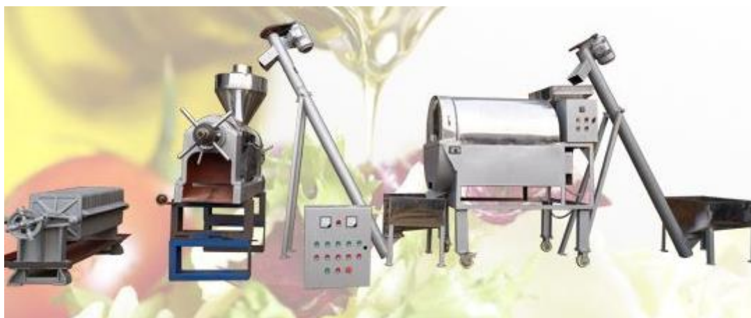
Рисунок 2.2 – Удосконалена міні-лінія виробництва кунжутної олії
