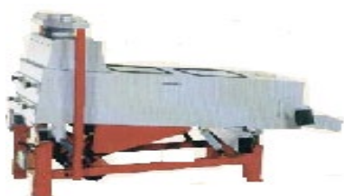
Рис. 2.1 Вібрційний сепаратор СПВ-01
