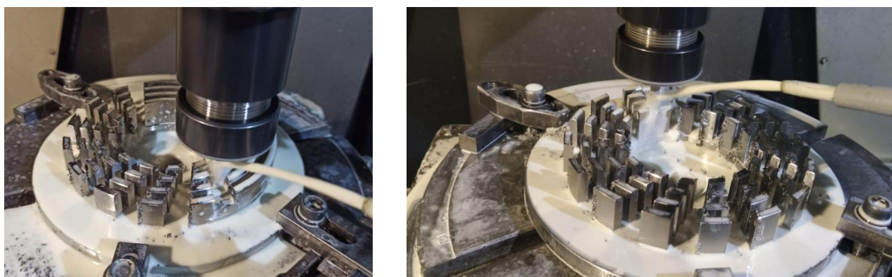
Рисунок 4.4 – Процес виготовлення ротора і статора експериментального зразка кавітаційного диспергатор-гомогенізатора на фрезерному станку з числовим програмним керуванням
