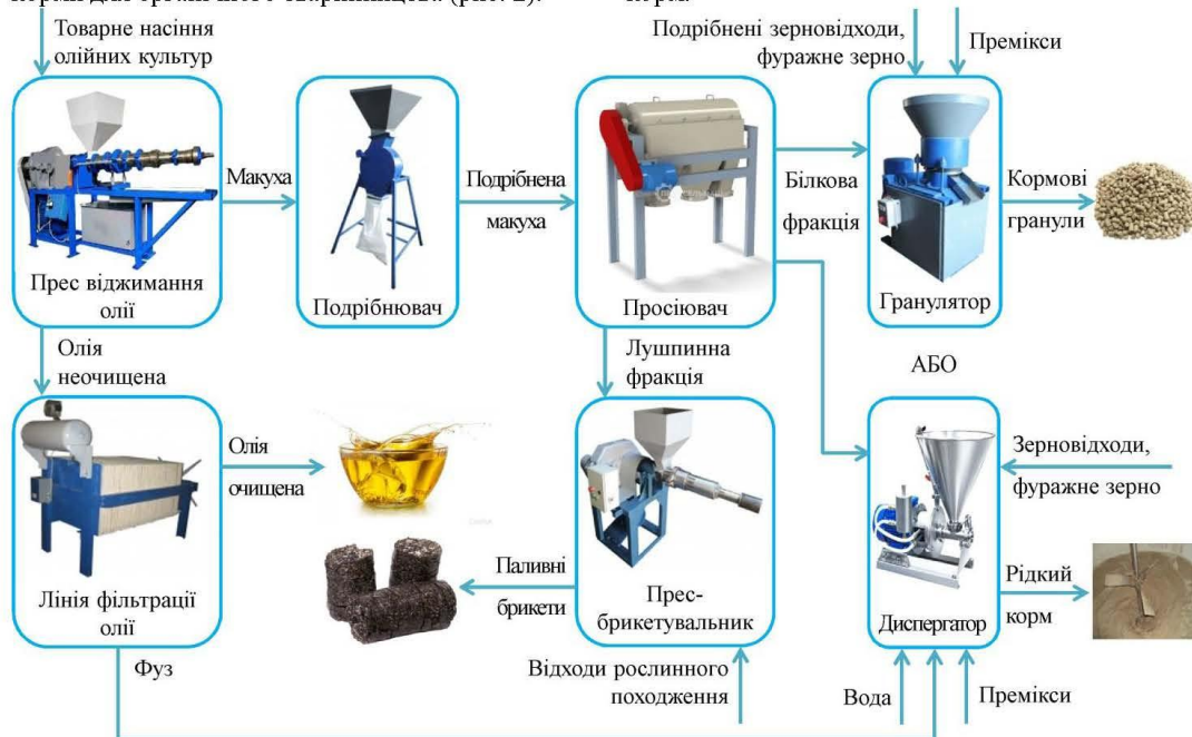
Рис. 2. Удосконалена технологічна лінія комплексної безвідходної переробки рослинної сировини олійних культур у корми для органічного тваринництва
