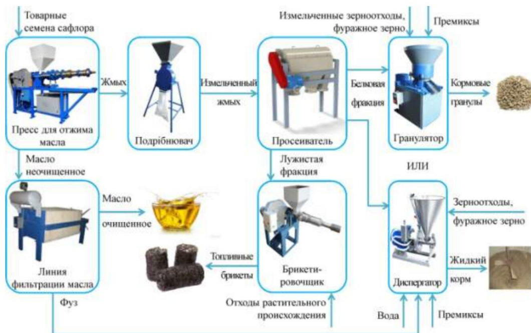
Рисунок 1 – Усовершенствованная технологическая линия комплексной безотходной переработки семян сафлора в корма для органического животноводства
