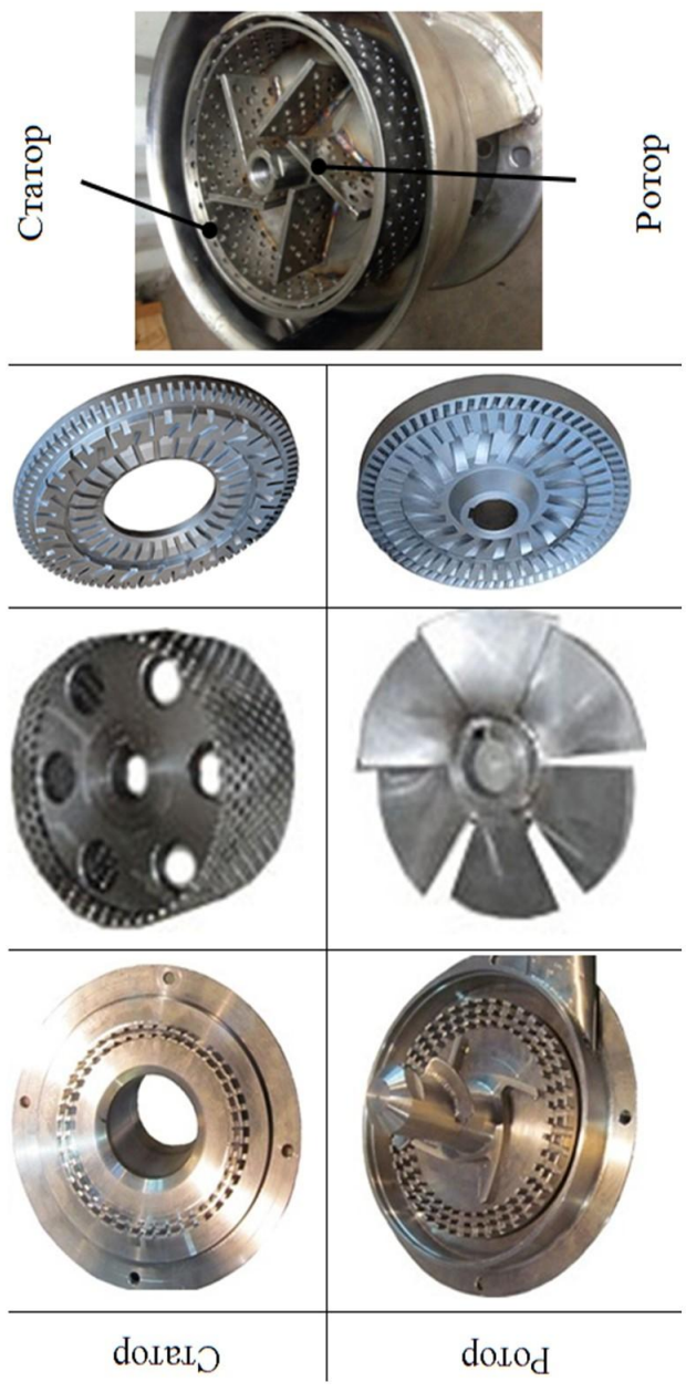
Робочі органи кавітаційних гідроударних диспергаторів
