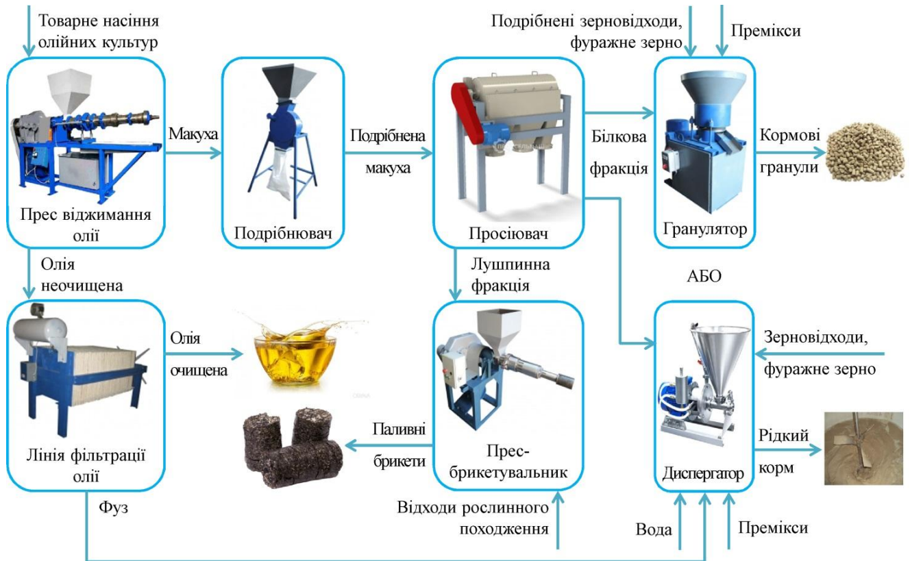
Рисунок 1.2 – Удосконалена технологічна лінія комплексної безвідходної переробки рослинної сировини олійних культур у корми для органічного тваринництва
