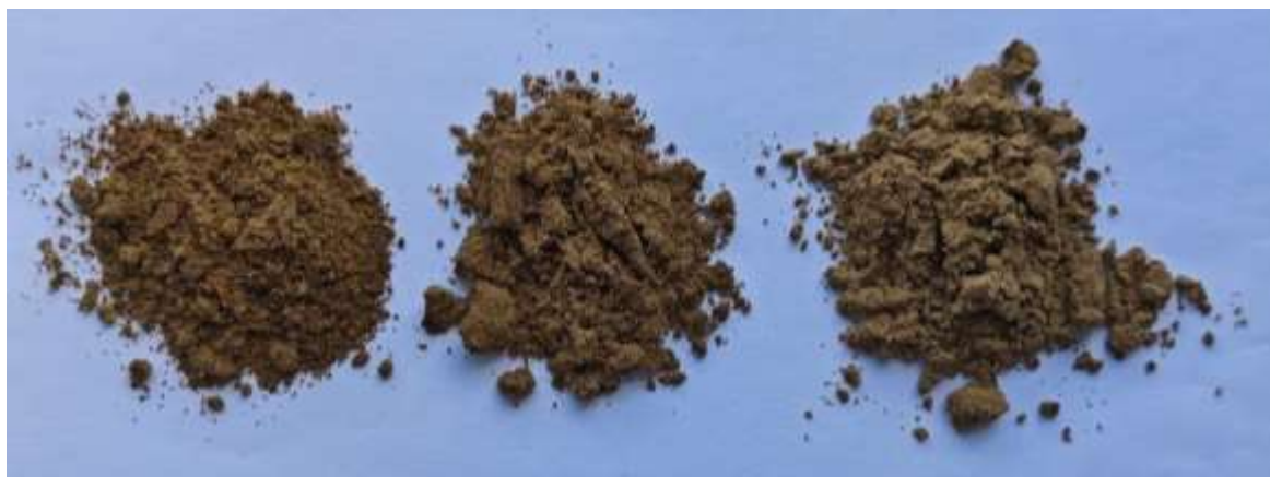
Рисунок 3.1 – Зовнішній вигляд одержаних фракцій подрібненої макухи із насіння чіа, зліва на право: схід з сита 0,56 мм, схід з сита 0,2 мм, прохід через сито 0,2 мм
