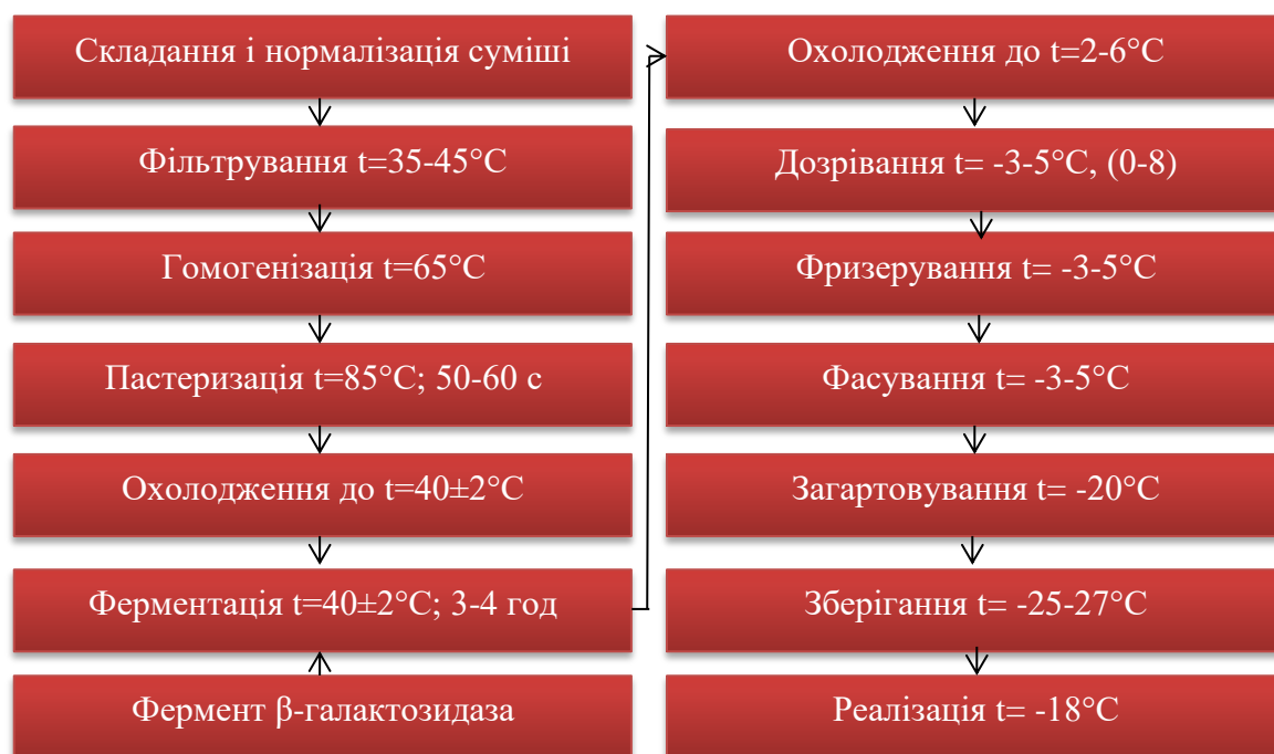
Рисунок 3.2 – Технологічна схема виробництва низьколактозного морозива
