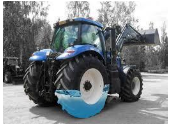
Рис 1.3. Баластування з використанням вантажів (а) та води (б)
