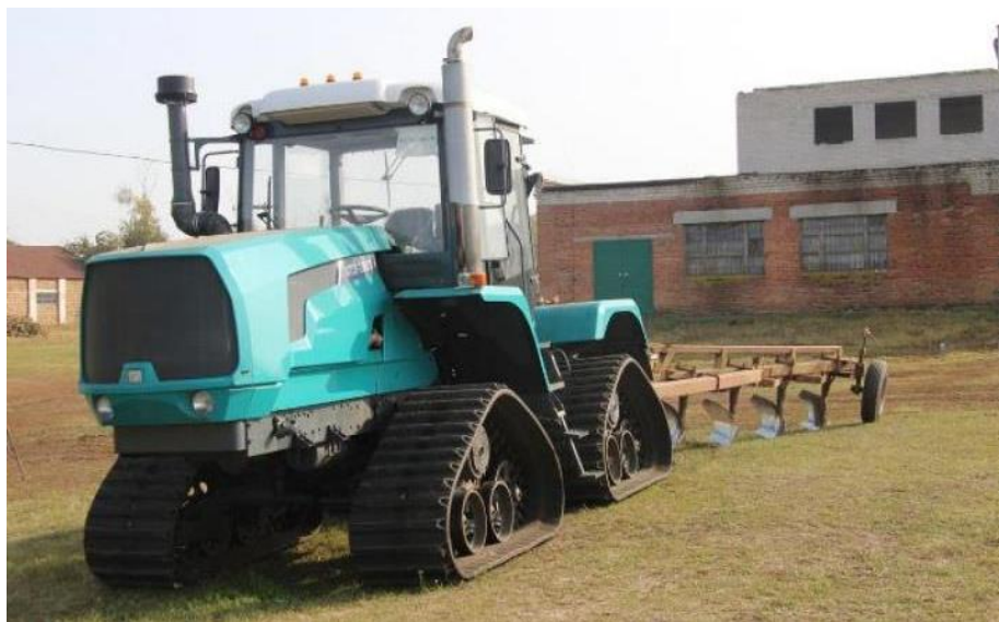
Рисунок 1.4 – Переобладнання з колісного на гусеничний рушій тракторів загального призначення ХТЗ
