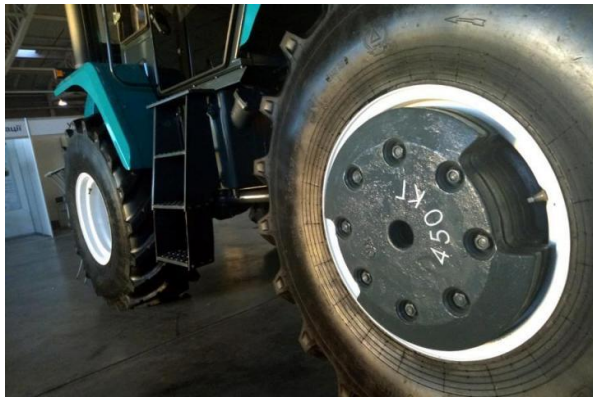
Рис 1.3. Баластування з використанням вантажів (а) та води (б)
