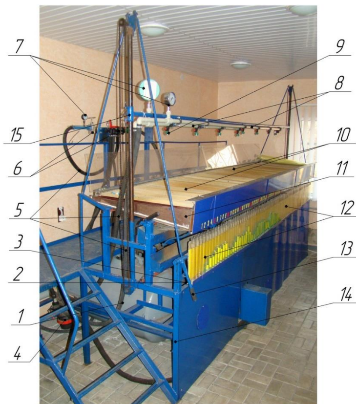
Рис. 3.3. Загальний вид гідравлічного станду для вимірювання параметрів розпилювачів: 1 – бак; 2 – насос; 3 – електродвигун; 4 – фільтр; 5 – рукав; 6 – регулятор тиску; 7 – манометр; 8 – штанга; 9 – розпилююча головка з розпилювачем; 10 – розподільвачі ; 11 – жолоб; 12 – мірні колби; 13 – поворотний механізм; 14 – рама; 15 – тримач
