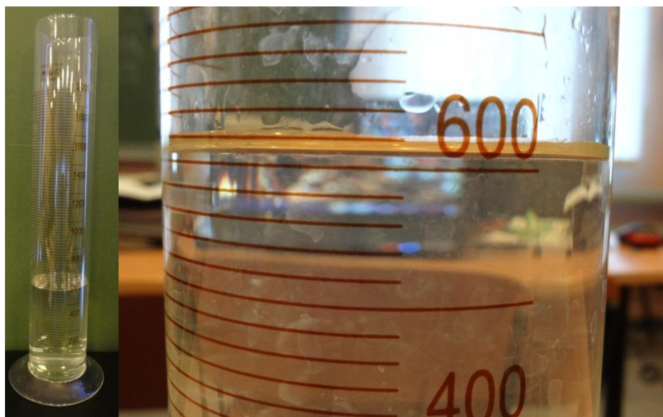
Рис. 3.6. Загальний вид мірного циліндра на 2000 мл., (ГОСТ 1770-74)
