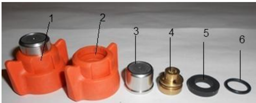
Рис. 3.1. Загальний вид та складові частини розпилювача
