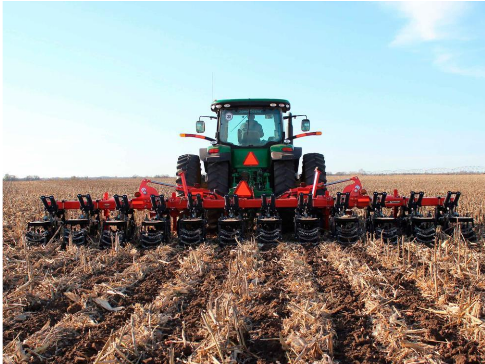
Рисунок 1.4 – Посів за технологією Strip-till
