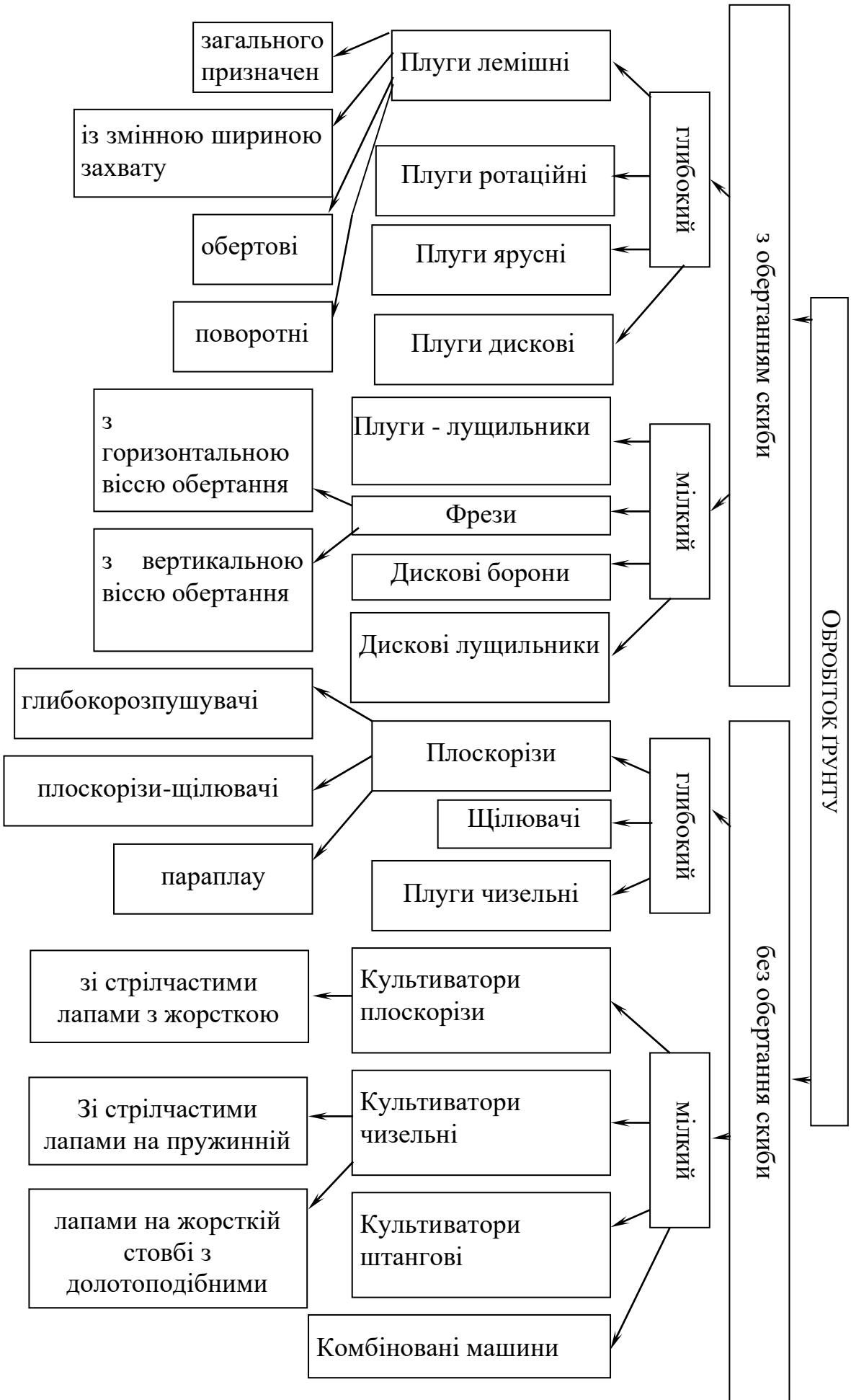
Рисунок 1.5 - Структурна схема способів обробітку ґрунту
