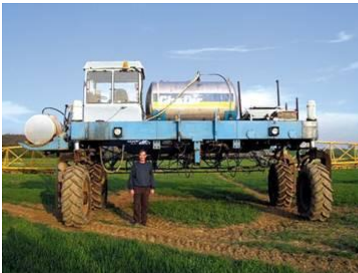
Рисунок 1.6 – Мостовий трактор з шириною прольоту 5,8 метра
