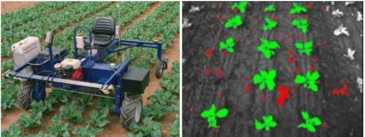
Рисунок – 1.3. Автономне шасі для проведення моніторингу та виконання операцій догляду за рослинами
