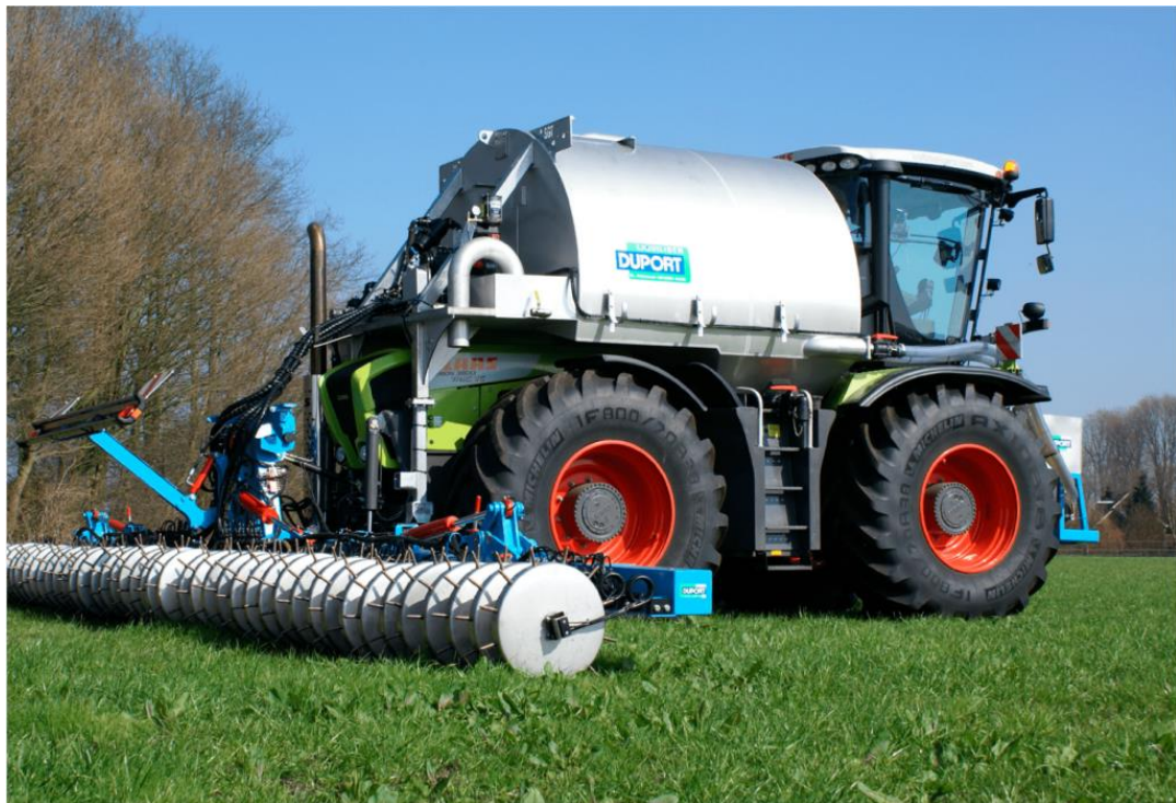
Рис. 2. Причіпний агрегат для внесення рідких мінеральних добрив інжекторним імпульсним вприскуванням в ґрунт на глибину до 8 см компанії DUPORT
