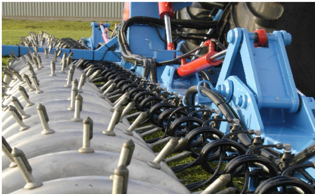
Рис. 3. Змінний модуль з інжекторними колесами для вприскування в ґрунт рідких мінеральних добрив
