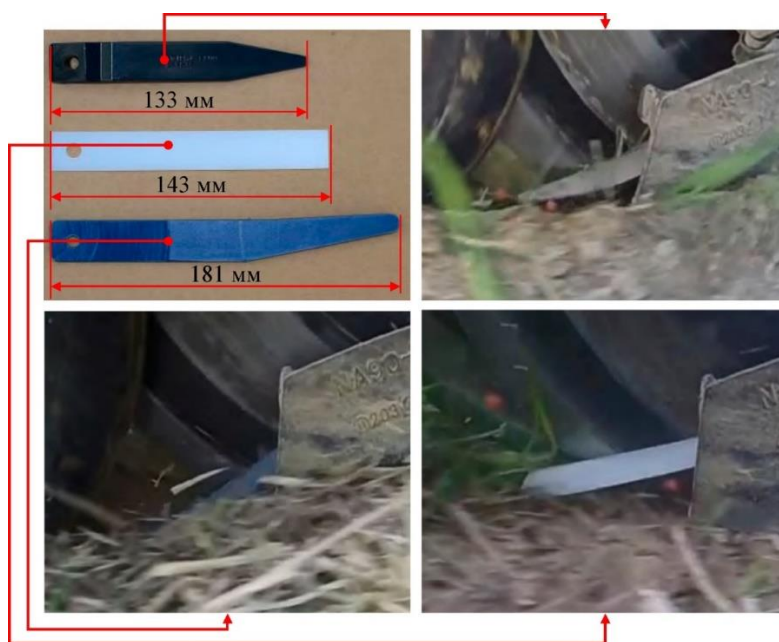
Рис. 2. Результати випробування заспокоювачів насіння різних конструкцій
