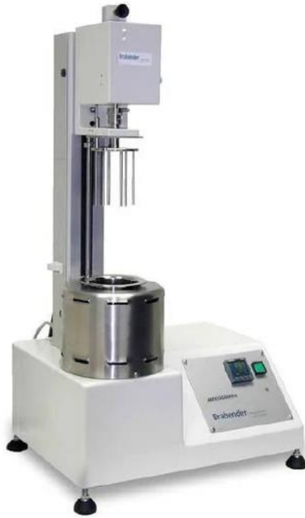
Рисунок 3.9 – Амілограф лабораторний для комплексного дослідження борошна та зерна
