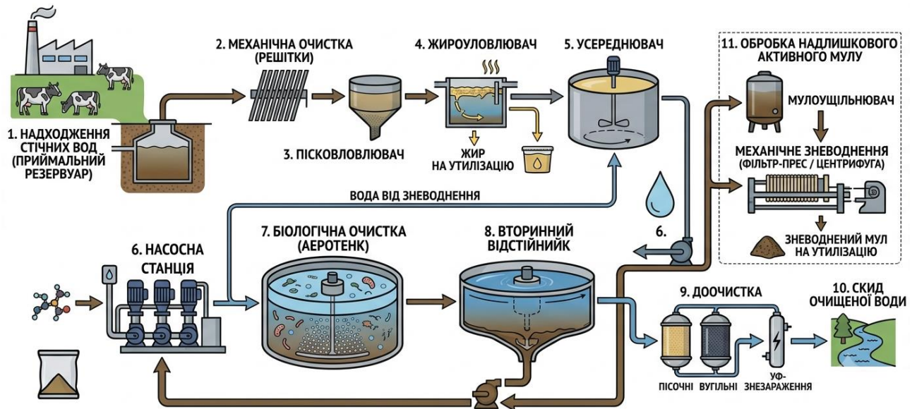
Рисунок 3.5. Технологічна схема експлуатації очисного обладнання на підприємстві молочної галузі
