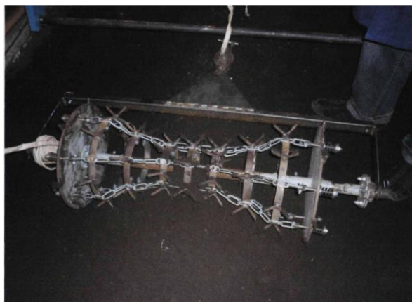
Рис. 3.4. Ротаційна борона з V-подібним зубом.
