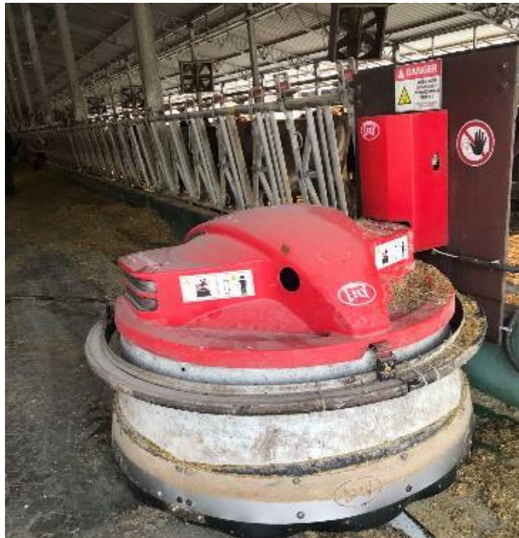
Рис. 8. Робот, що підгортає корм до годівниць
