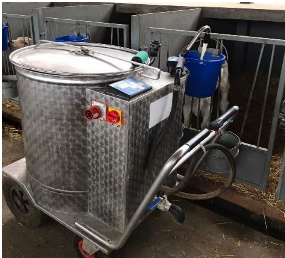
Рис. 5. Молочне таксі, що доставляє тепле молоко в бокси до телят
