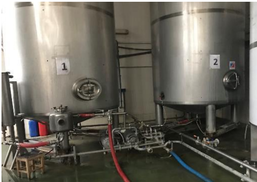
Рис. 11. Молочні танки для зберігання молочної сировини
