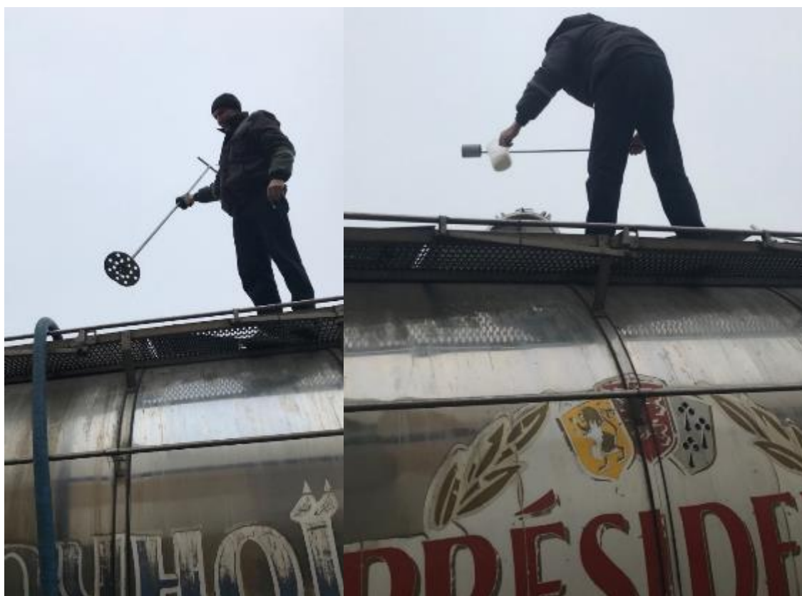
Рис. 13. Відбір проб молока з молоковозу
