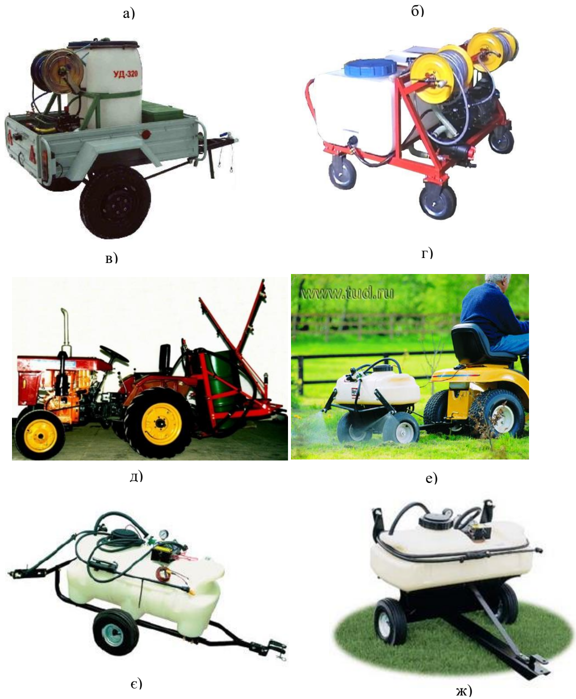
Рисунок 1.2 - Конструктивні особливості сучасних малогабаритних обприскувачів
