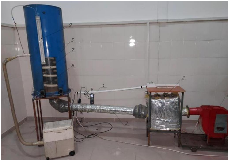
Рисунок 3.14 – Фотографія експериментальної установки для активного вентиляювання зерна
