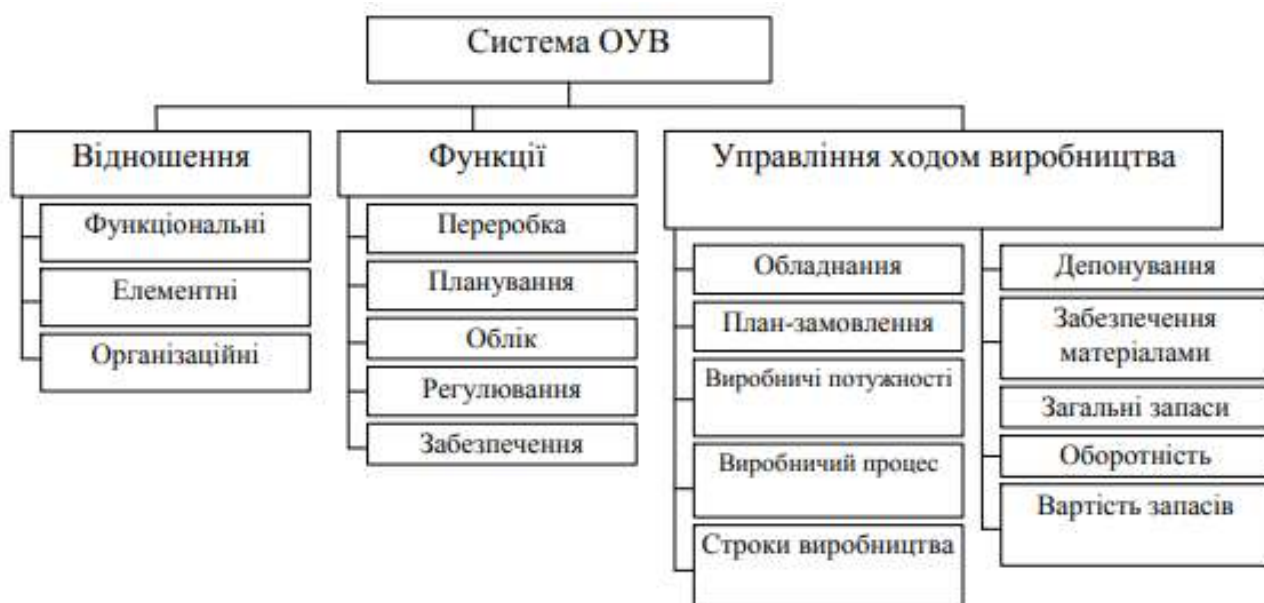
Рис. 1.5. Схема структури системи оперативного управління виробництвом
