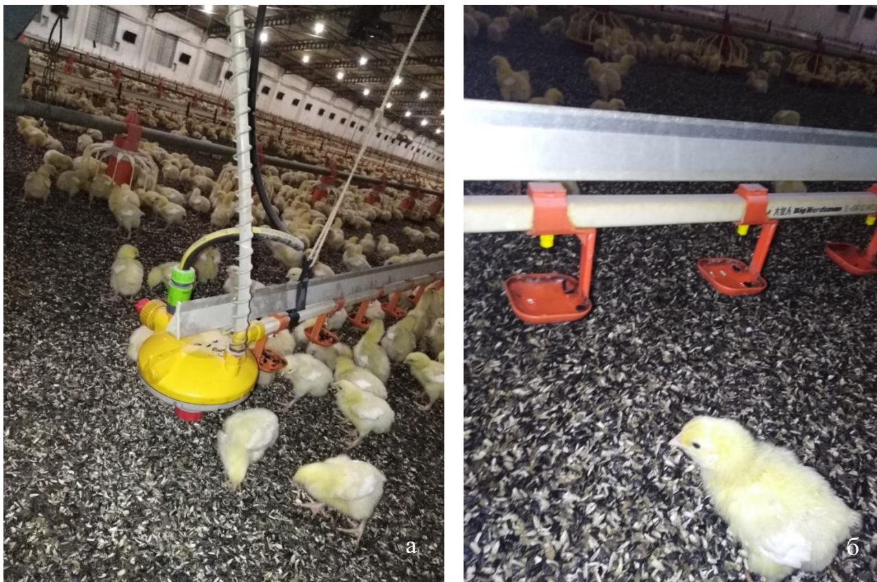
Рис. 11. Лінії напування застосовані у пташниках відділення «Центральне» ТОВ «Птахокомплекс «Дніпровський»: а) редуктор для контролю тиску; б) ніпелі з крапельницями
