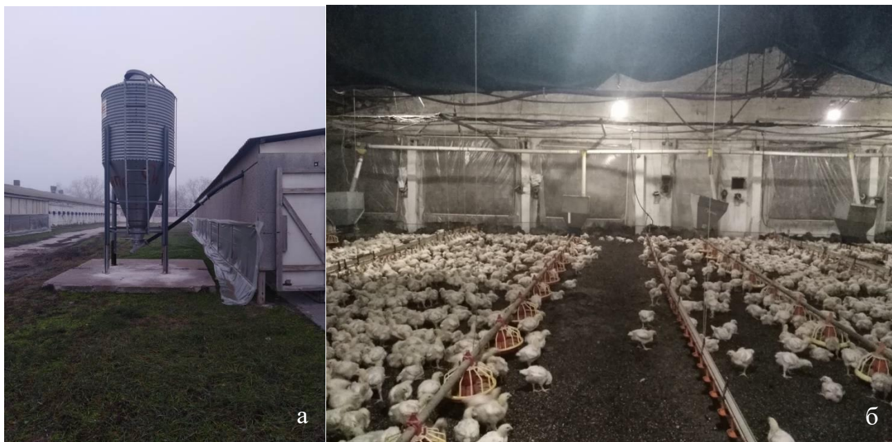
Рис. 9. Система подачі кормів застосована у пташниках відділення «Центральне» ТОВ «Птахокомплекс «Дніпровський»: а) зовні розташований бункер для зберігання кормів; б) внутрішня лінія подачі кормів оснащена хоперами з сенсорними датчиками
