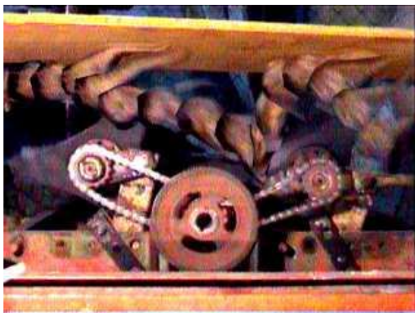
Рисунок 4.2 - Траєкторія руху коренеплоду вздовж конвейєра-очищувача отримана шляхом суміщення кадрів
