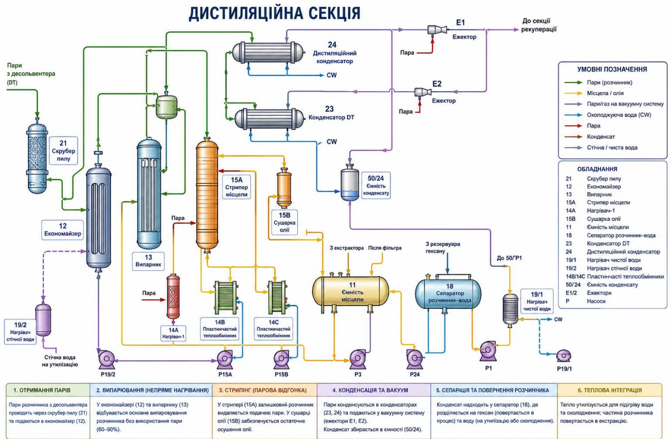
Рисунок 2.3 – Технологічна схема дистиляційної секції
