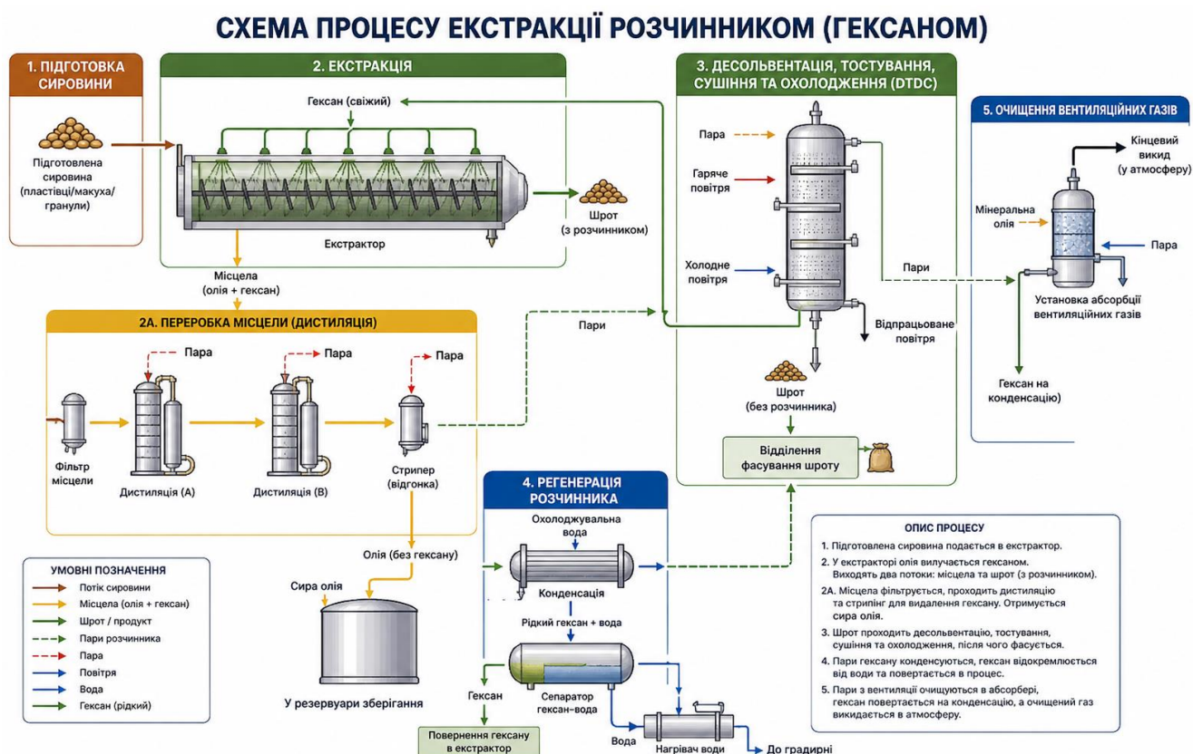
Рисунок 2.1 – Схема процесу екстракції розчинником (гексаном)
