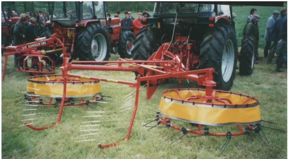
Рисунок 3.10 - Граблі - ворушилка з відцентровими граблинами
