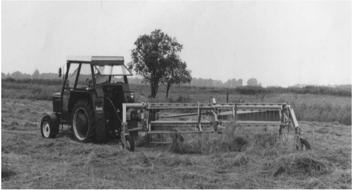
Рисунок 3.9 - Барабанні граблі - ворущилка ГБУ 6 на ворущінні
