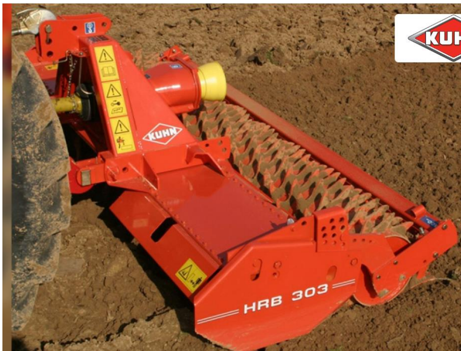
Рис.2.1. Культиватор фрезерного типу з горизонтальним розміщенням робочих органів для суцільного обробітку ґрунту - KUNH HRB-303
