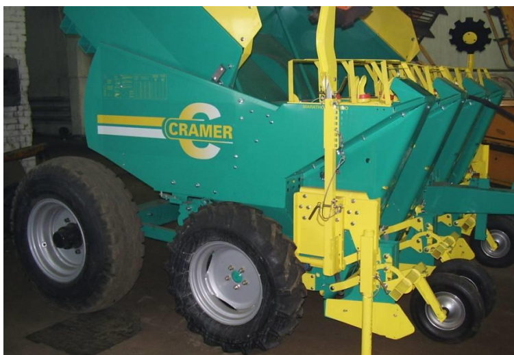
Рис.2.2. Напівнавісна чотирирядна картоплесаджалка CRAMER
