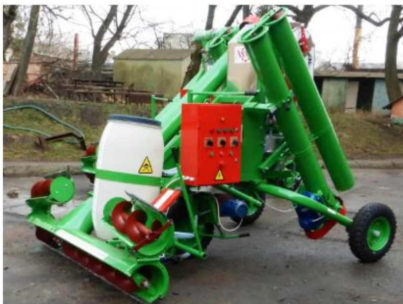
Рис.2.8 Протруювач камерний ПК-20
