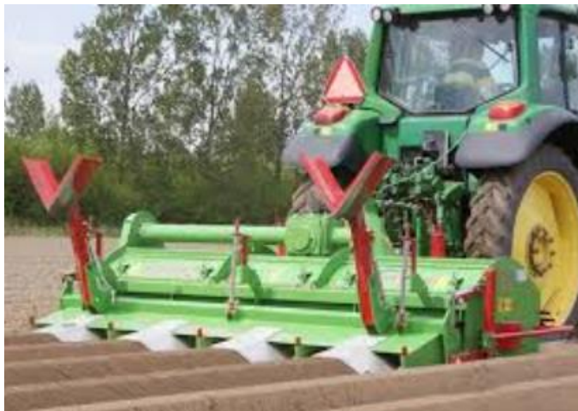
Рис. 2.3. Вертикально-фрезерного культиватор гребнеутворювач BASELIER FK-310
