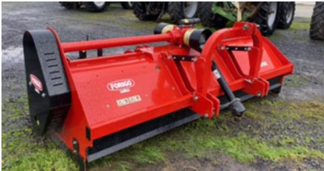
Рис. 2.5. Машина для видалення бадилля FORIGO FTP 4X75
