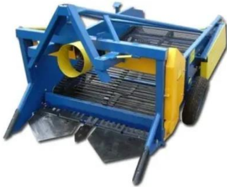
Рис.2.6. Навісний дворядний картоплекопач КТН-2ВМ
