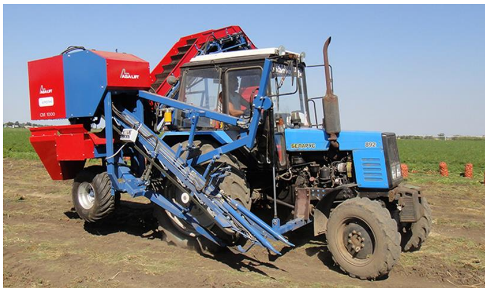
Рисунок 2.8 – Машина для збирання столових коренеплодів фірми ASA-LIFT
