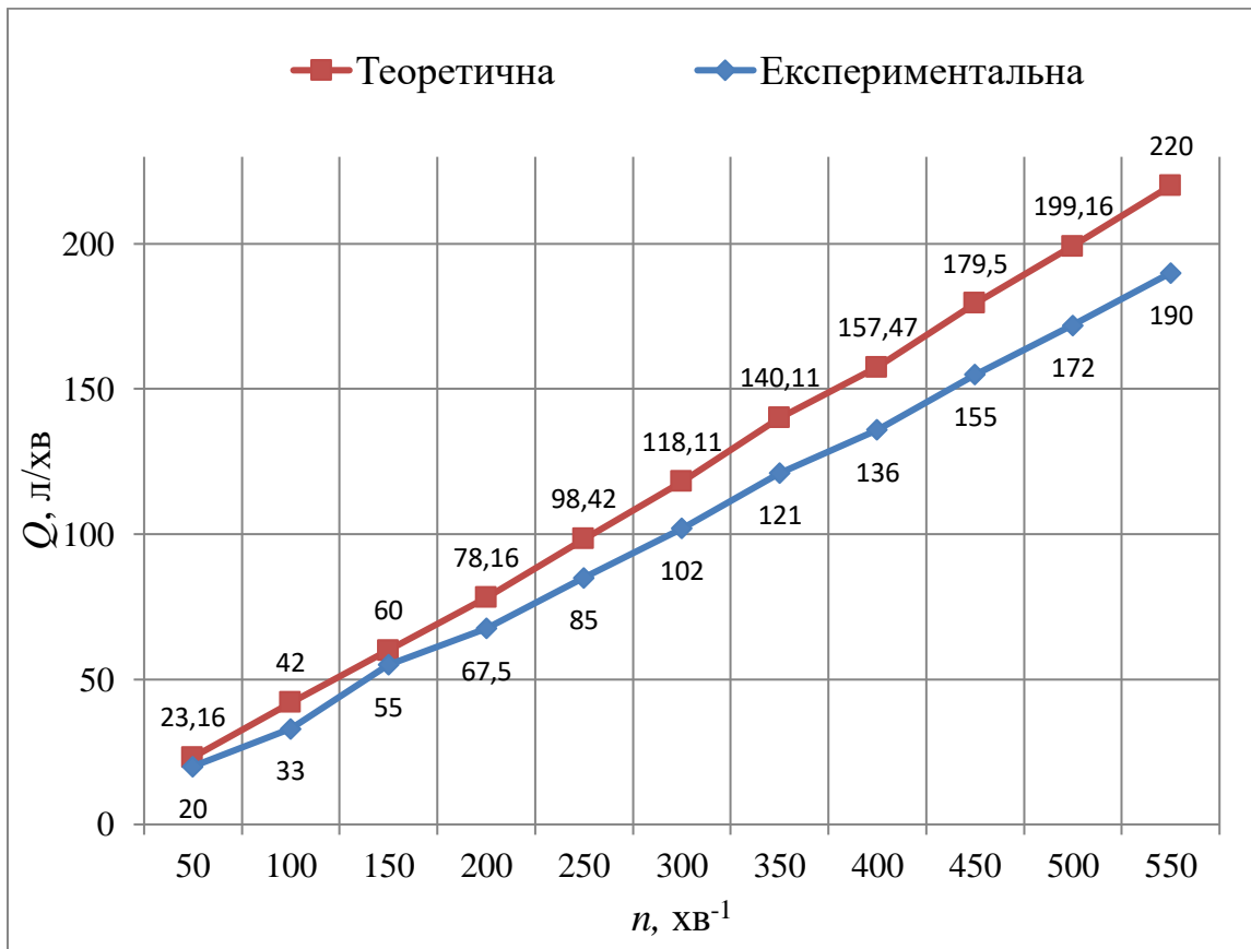
Рис. 4.1. Залежність теоретичної \blacksquare і експериментальної \blacklozenge витрати від частоти обертання електродвигуна \text{хв}^{-1}
