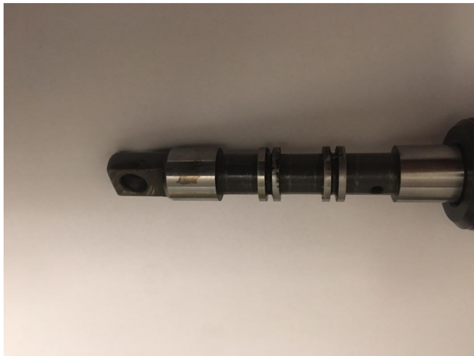
Рис. 1.4 – Гідроабразивне зношування пояса золотника.
