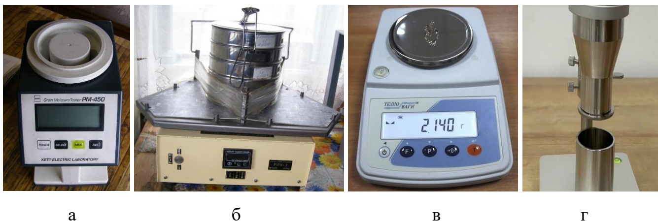
а – вологомір Kett PM-450; б – лабораторний розсів РЛУ-3; в – електронні лабораторні ваги TBE-0,6-0,01; г – прилад для визначення щільності ASTM K-6721
