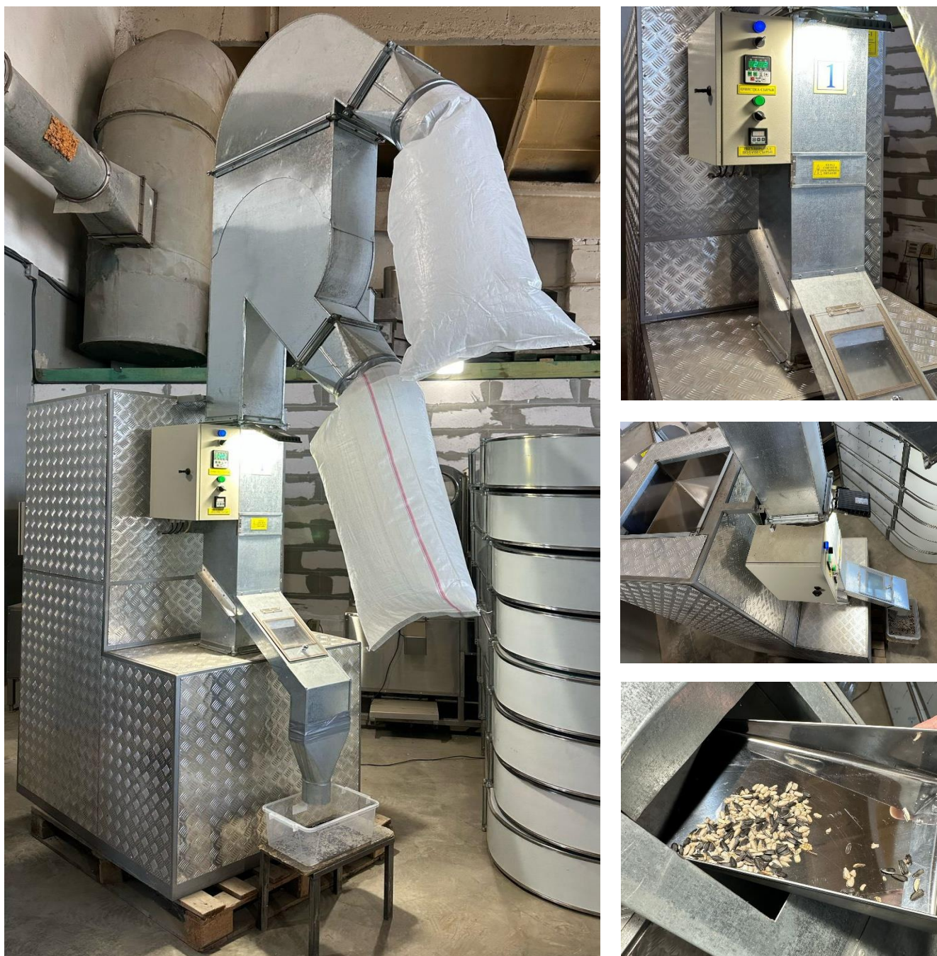
Рисунок 3.7 – Загальний вигляд експериментального зразка аеродинамічного сепаратора колонного типу
