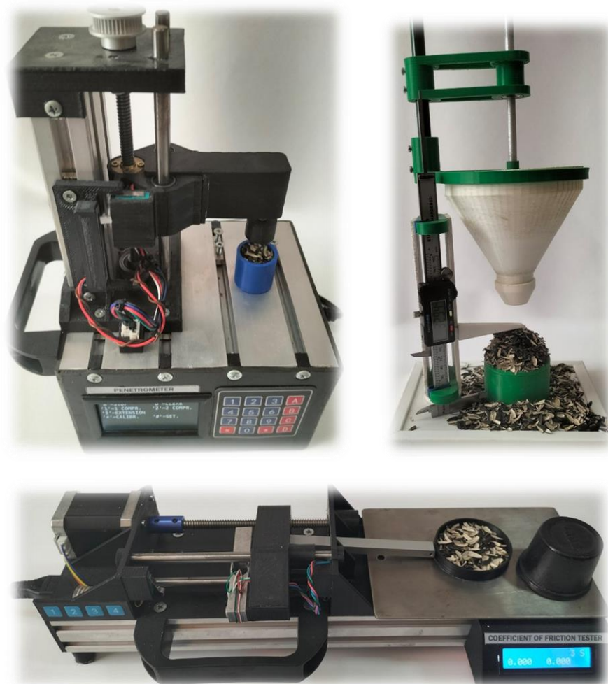
Рисунок 4.2 – Процес досліджень фізико-механічних властивостей компонентів відходів насіннєвої суміші соняшнику на лабораторному обладнанні
